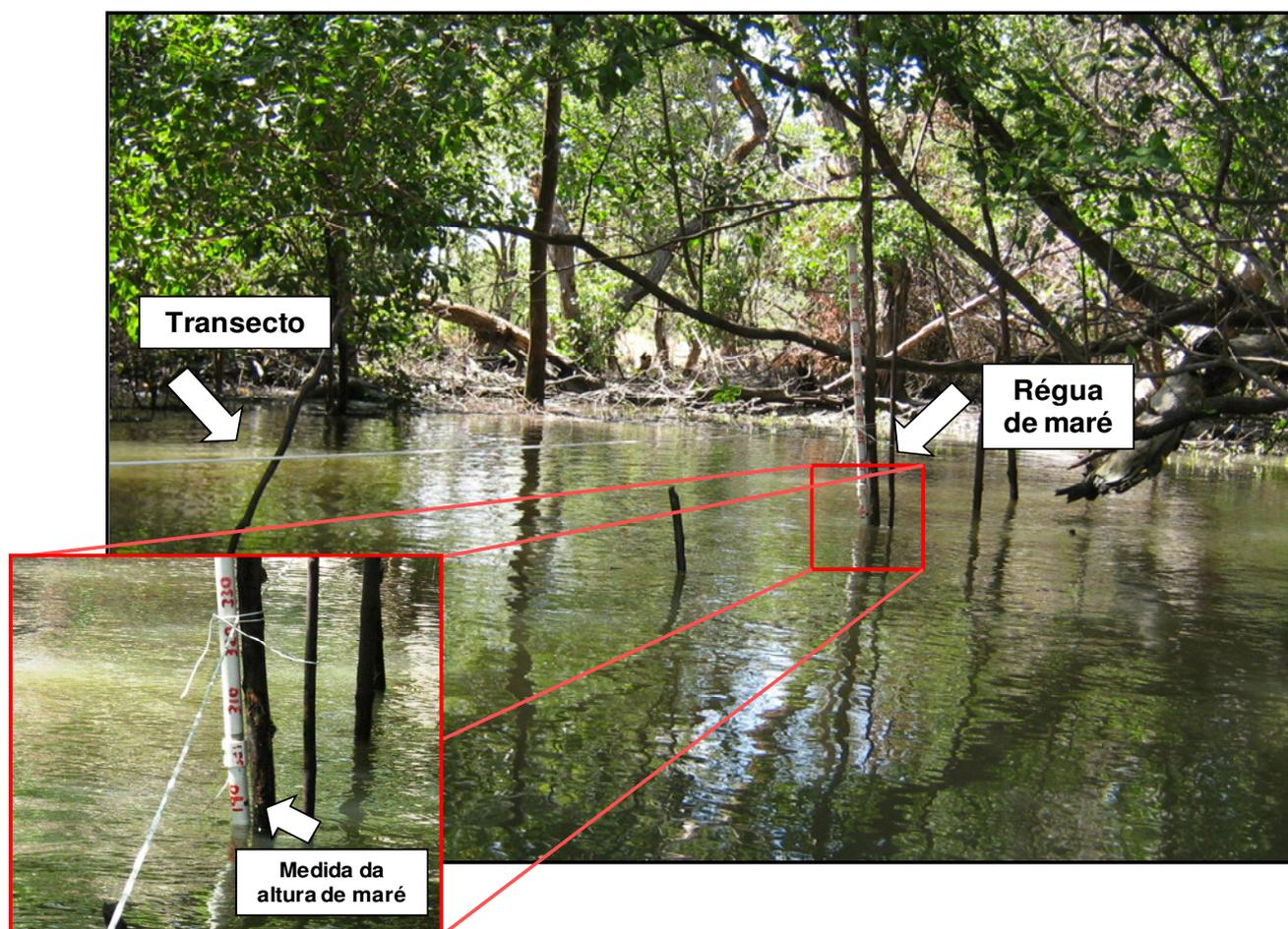
FIGURA 06: Perfil da gamboa do Rio Jaguaribe durante a maré enchente. Detalhe para medição da altura de maré com régua.
