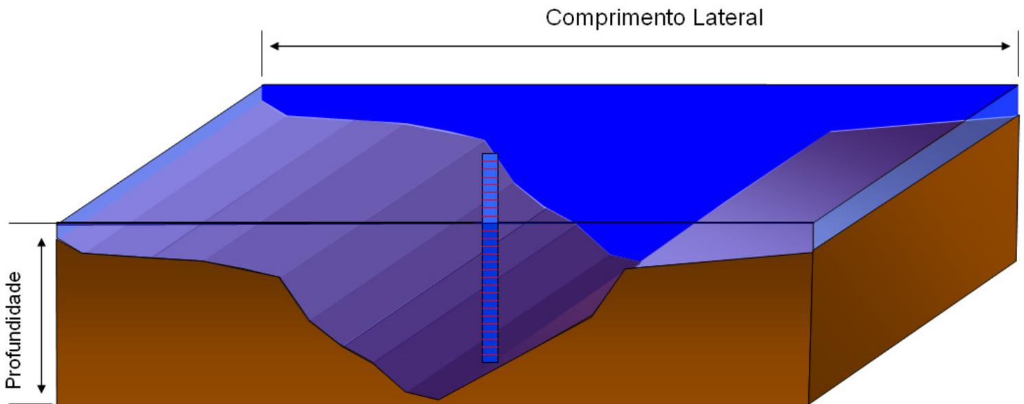
FIGURA 05: Modelo esquemático escolhido para as campanhas. A profundidade foi medida por régua métrica colocada no local mais fundo da gamboa e o comprimento lateral foi medido com auxílio de uma fita métrica presa durante o horário de maior maré para medição estimada da planície de inundação. Foram medidas profundidades a cada metro de comprimento lateral para obtenção das respectivas áreas de cada gamboa, inundada ao longo do ciclo de maré.
