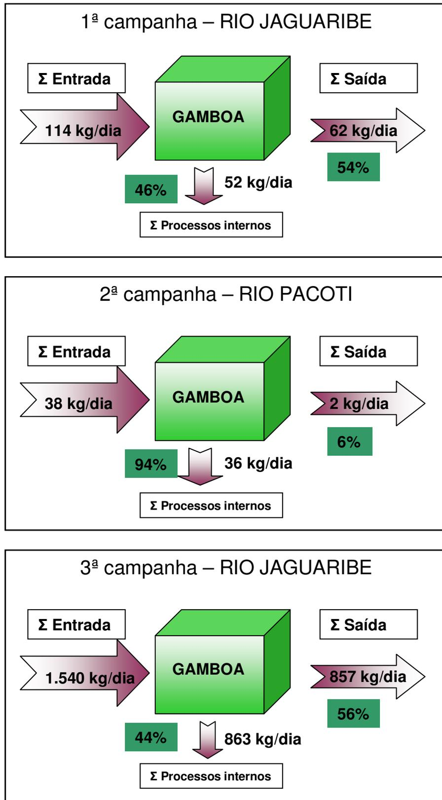
FIGURA 18: Balanços de massa de **fósforo total (T-PO<sub>4</sub>)** para as três gamboas durante as três campanhas realizadas.
