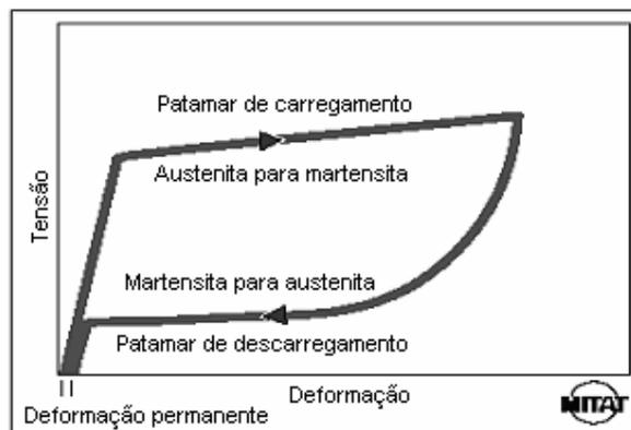
Figura 7: Curva tensão-deformação esquemática para NiTi superelástico (Pelton, 2000, p. 111).
