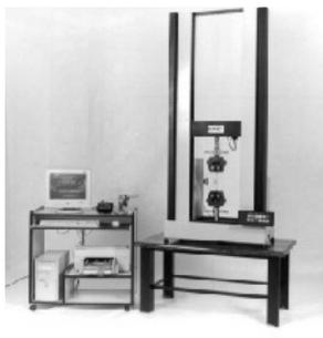
Figura 44: Máquina universal de ensaios, marca EMIC.
