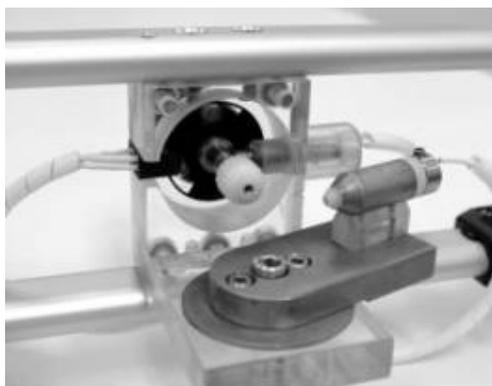
Figura 46: Máquina de ensaio de fadiga por flexão rotacional – Flextest.
