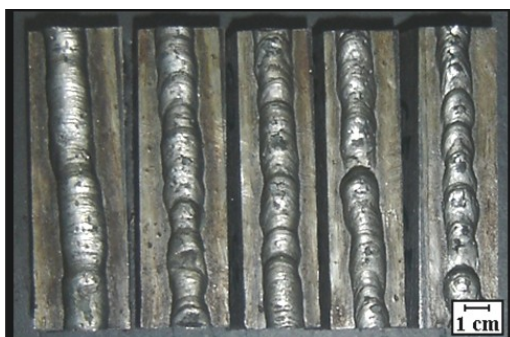
6.6 b) Corrente de soldagem: (A) =90A, Diâmetro do eletrodo: \Phi_e : 3,25 mm. Velocidades de soldagem: 8, 12, 16, 20 e 24 cm/min da esquerda para direita.
