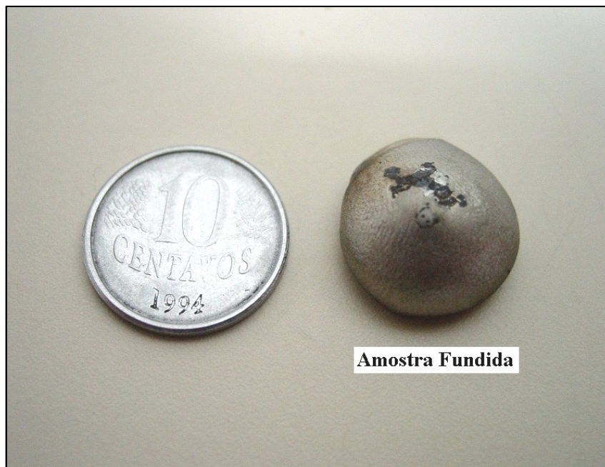
Figura 5.8: Detalhe da amostra fundida no forno a arco TIG.
