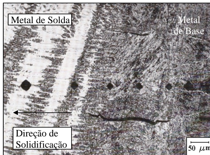
Figura 3.22: Trincas situadas sobre a ZPD. Indentações de microdureza comprovam a maior dureza quando comparado aos metais de base e de solda. Rowe et. al. (1999)
