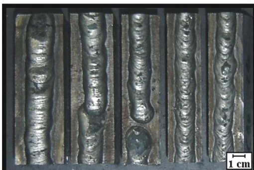
6.6 a) Corrente de soldagem: (A) =90A. Diâmetro do eletrodo: \Phi_e : 3,25 mm. Velocidades de soldagem: 8, 12, 16, 20 e 24 cm/min da esquerda para direita.
