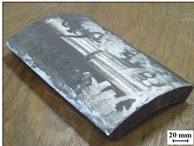
Figura 4.1: Metal de base preparado para ensaios de deposição sobre chapa.
