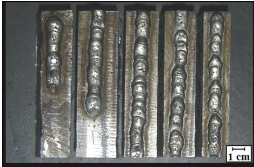
Figura 6.6: Soldas depositadas sem preaquecimento em diferentes energias de soldagem.
