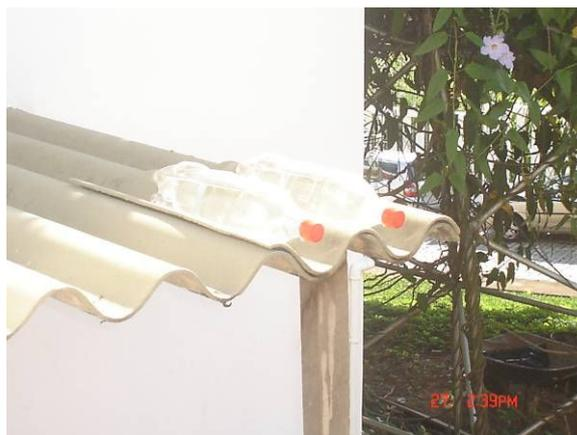
**Figura 14.** Tratamento alternativo da água para beber empregando a radiação UV solar para desinfecção.
