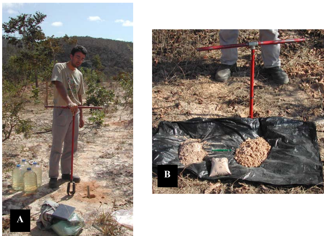
Figura 3.2: A) Trado; B) Amostras retiradas do trado. Fotos: da Costa 2005.
