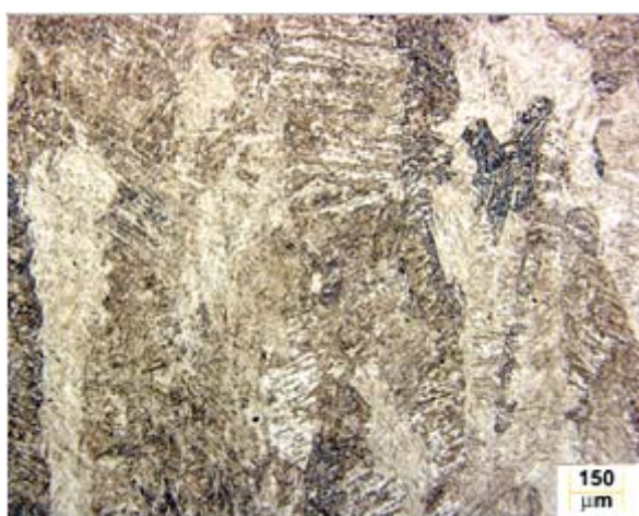
Figura 59 – Microestruturas na solda realizada sem martelamento; (a) Região próxima à superfície do cordão observada com dois aumentos diferentes; (1a) Região próxima à superfície do último cordão; (b) região central do cordão; (c) Linha de fusão entre o penúltimo e último cordões. Ataque Nital 2%
