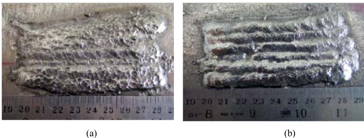
Figura 37 – Superfícies marteladas; (a) com punção (b) com agulhas.
