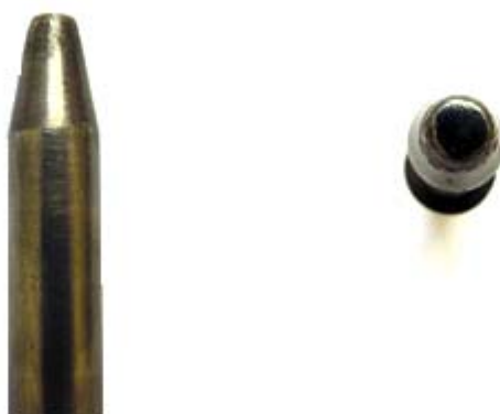
Figura 56 – Ferramenta danificada em função da alta dureza do material de adição E-502-15.
