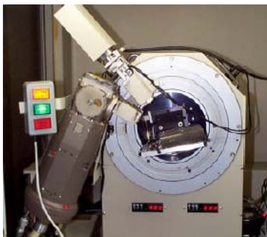
Figura 7 – Exemplo prático de uma Fonte de raios-X, executando o ensaio em uma amostra [8].
