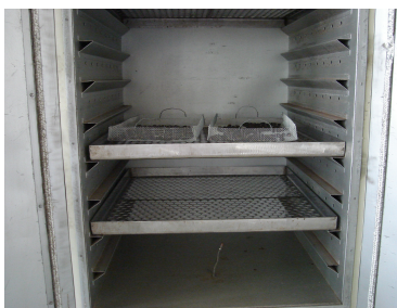
Figura 8. Estufa utilizada para secagem das sementes de pinhão manso
