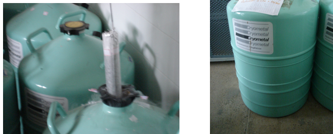
Figura 10. Canister colocado no interior do botijão criogênico
