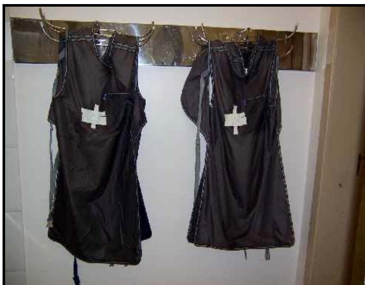
FIGURA 22 – Dosímetros fixados nos aventais protetores
