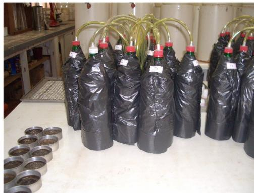
FIGURA 1. Garrafas PET utilizadas como biodigestores batelada.
