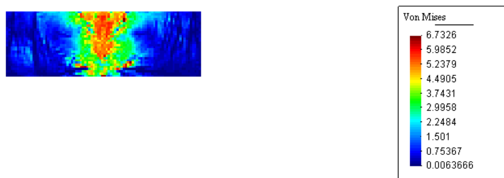
Figura11.53: Tensão de von Mises para carga F2
