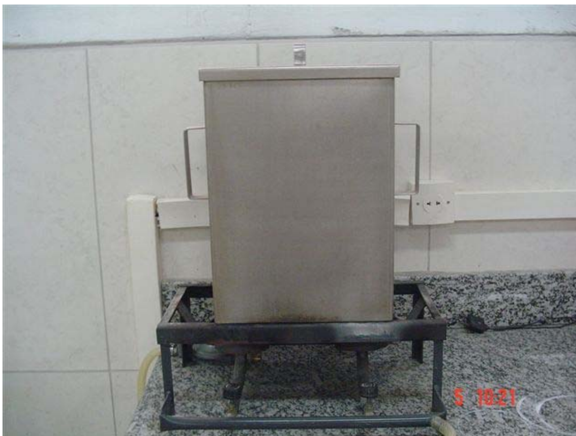
Figura 4.4 – Recipiente utilizado no ensaio de absorção.
