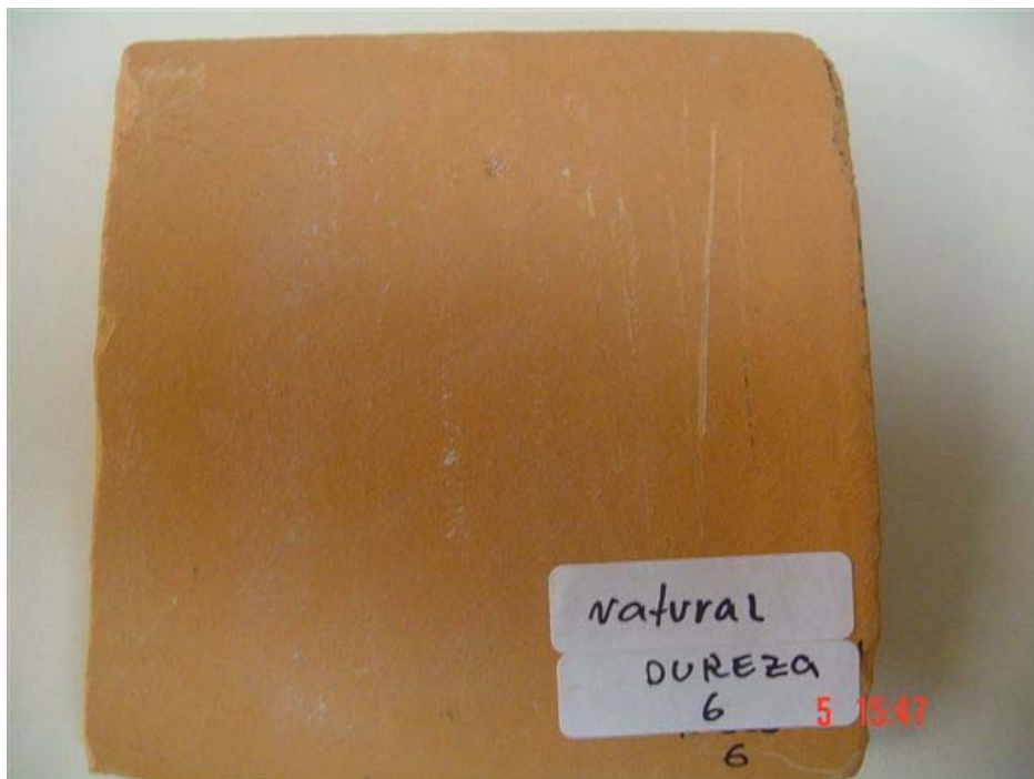
Figura 5.13 – Corpo de prova sem recobrimento superficial (natural) após a execução do ensaio de resistência ao risco.
