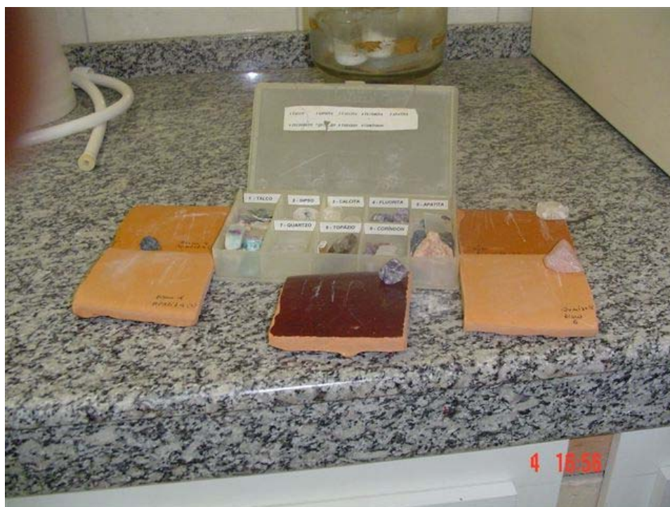
Figura 4.8 – Materiais utilizados no ensaio de resistência ao risco.
