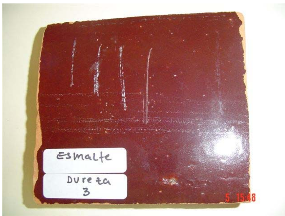
Figura 5.15 – Corpo de prova com recobrimento superficial esmaltado após a execução do ensaio de resistência ao risco.
