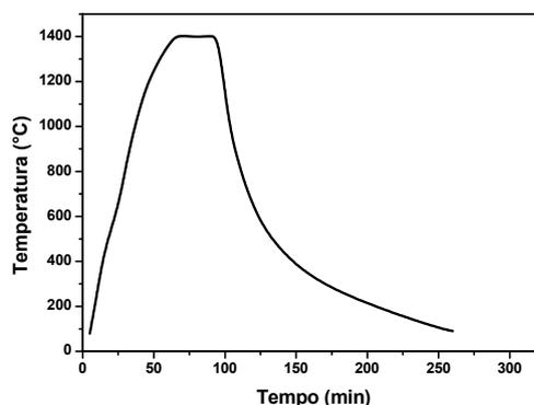
Figura 5.10 – Ciclo térmico de aquecimento com taxa máxima de aquecimento.
