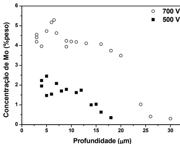
Figura 6.11 – Perfil de concentração de Mo das amostras enriquecidas a 1150 °C em 500 V e 700 V.
