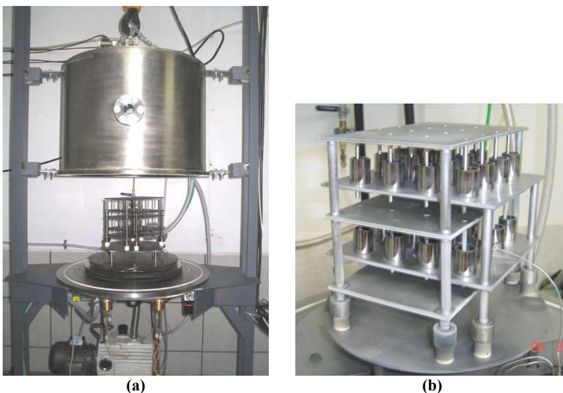
Figura 5.8 – (a) Reator a plasma e (b) detalhe do suporte para enriquecimento da superfície de buchas.
