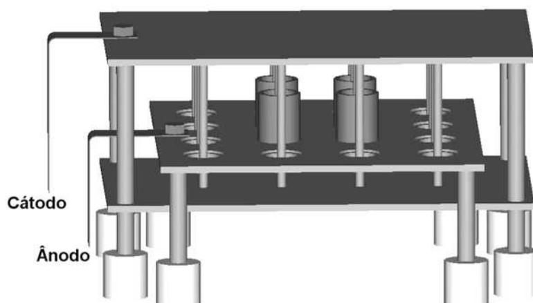
Figura 6.2 – Disposição das amostras no suporte de tratamento.
