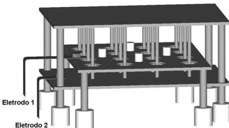
Figura 6.1 – Esquema do suporte de tratamento.
