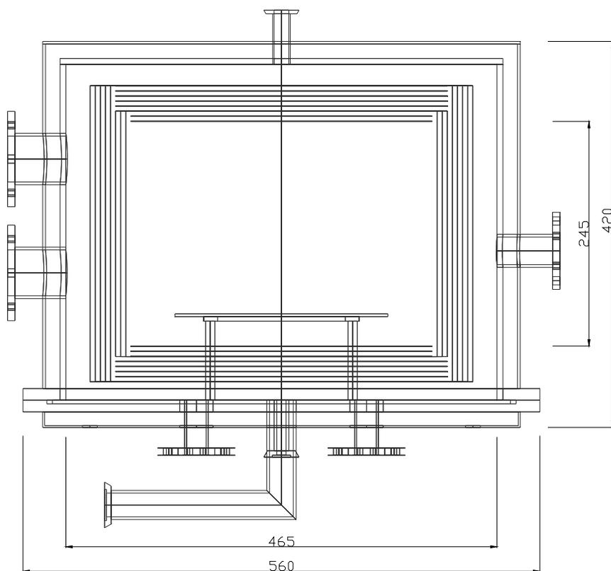
Figura 5.6 – Esquema da câmara de tratamento.
