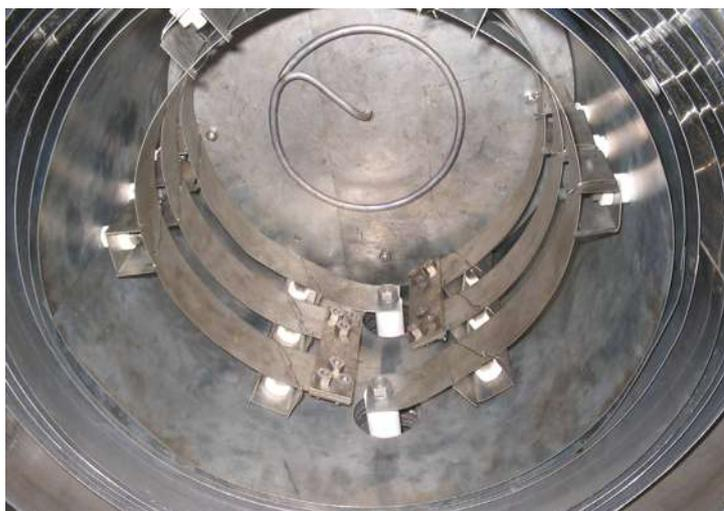
Figura 5.9 – Elementos resistivos do reator.
