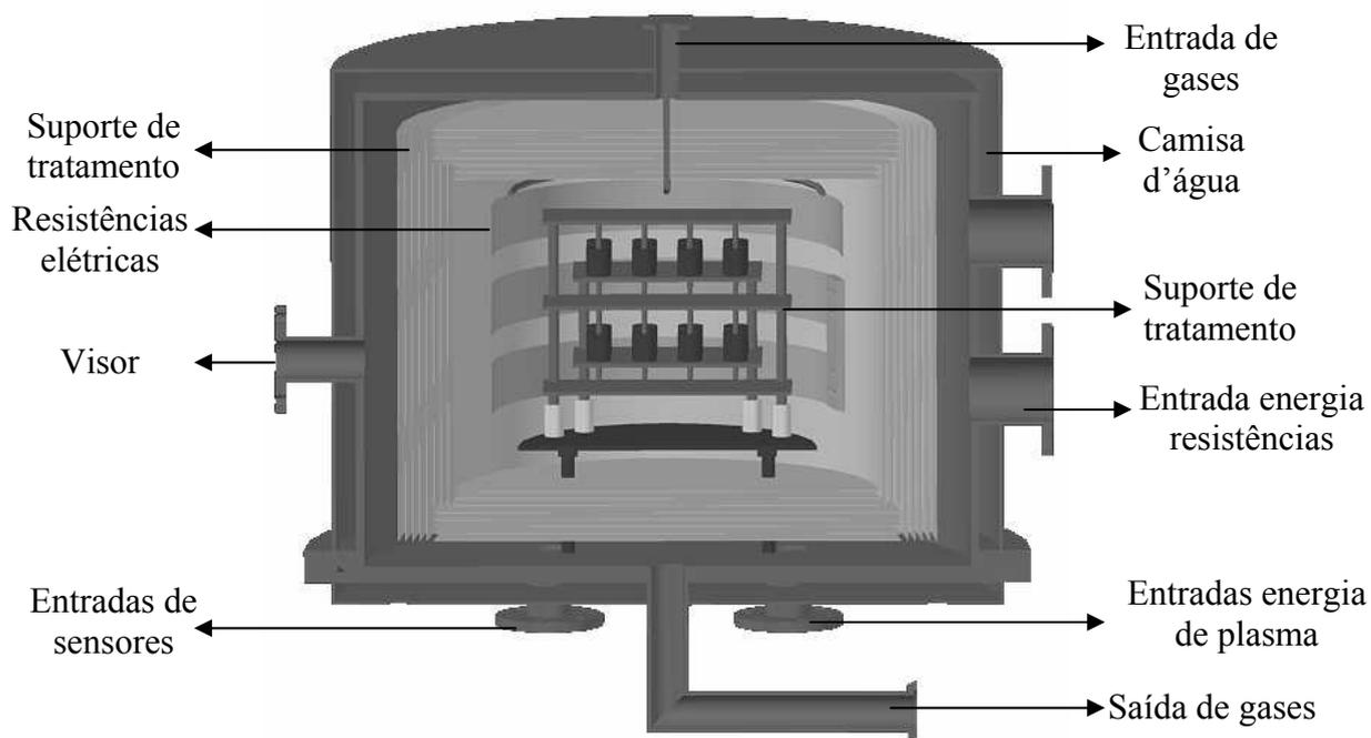
Figura 5.5 – Corte da câmara de tratamento.
