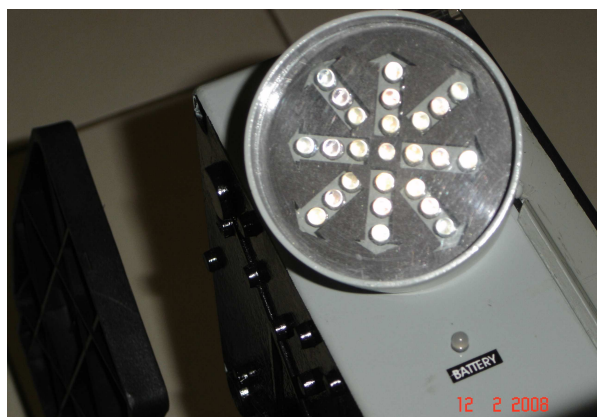
Figura 3.7: Display de leds com indicação do estado da bateria no módulo de controle.
