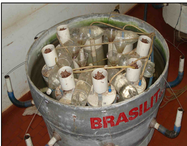
FIGURA 1. Biodigestores acondicionados em caixa de fibrocimento.
