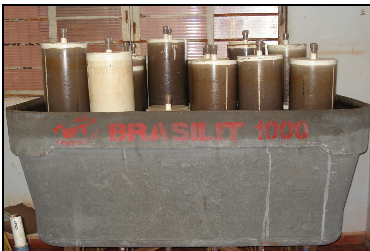
FIGURA 3. Gasômetros independentes acondicionados em caixa de fibrocimento.
