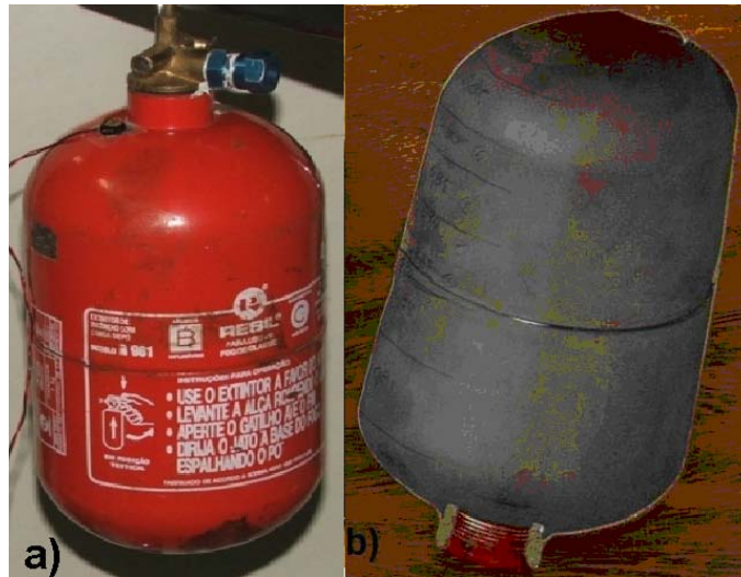
Figura 3.6: Extintor de incêndio automotivo utilizado para a realização dos ensaios e modelos: Suspensão pela válvula (a). Extintor em corte longitudinal (b).
