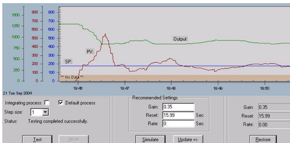
Figura 4.18 – Atuação do controle PI para consistência de 3%
