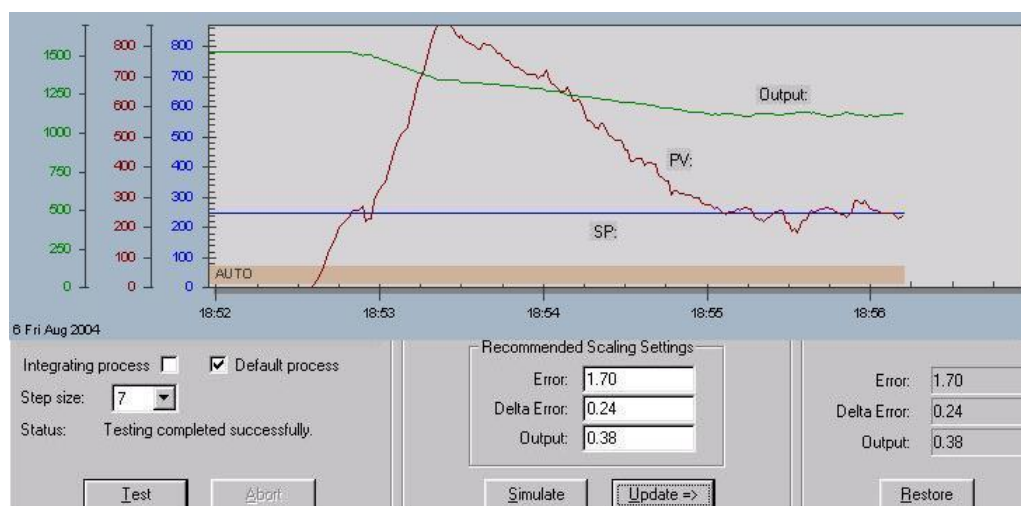
Figura 4.19 – Atuação do controle fuzzy para consistência de 5%
