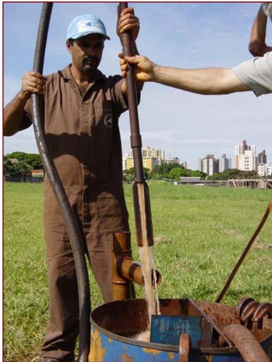
**FIGURA 6** - Trépano com circulação d'água, Belincanta (2004).
