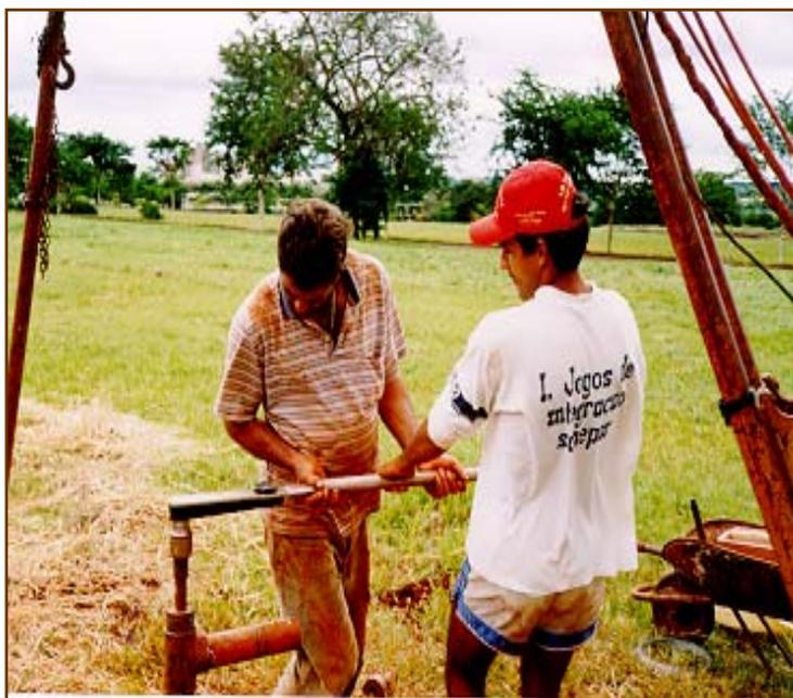
**FIGURA 9** - Torquímetro sendo utilizado logo após o ensaio SPT, Belincanta (2004).
