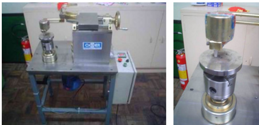
Figura 3.5 – Equipamento utilizado para a realização do ensaio de desgaste pino-sobre-disco (DAL COMUNI; FAGUNDES, 2004).
