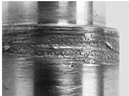
Figura 2.18 – Componente submetido ao mecanismo de desgaste adesivo (DESGASTE, 2005).
