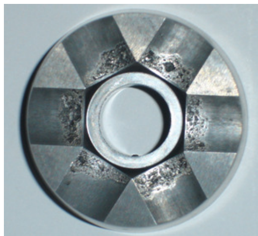
Figura 2.19 – Matriz de estampagem a frio de porcas sextavadas apresentando severo desgaste adesivo (CISER, 2005).
