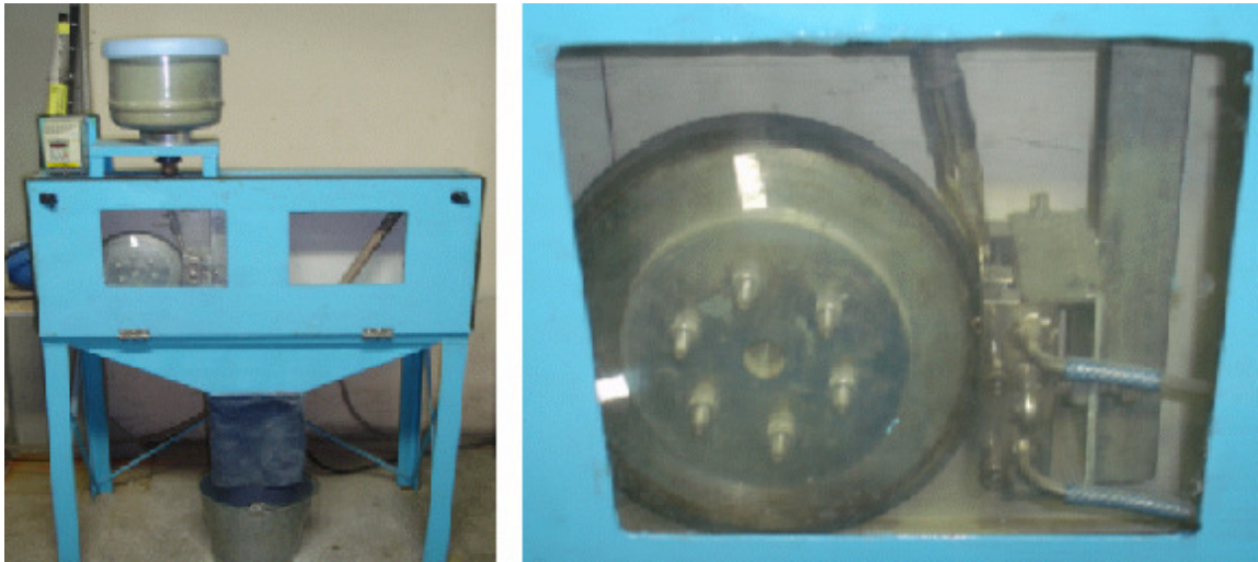
Figura 3.7 – Equipamento utilizado para a realização do ensaio de desgaste disco de borracha-areia abrasiva.
