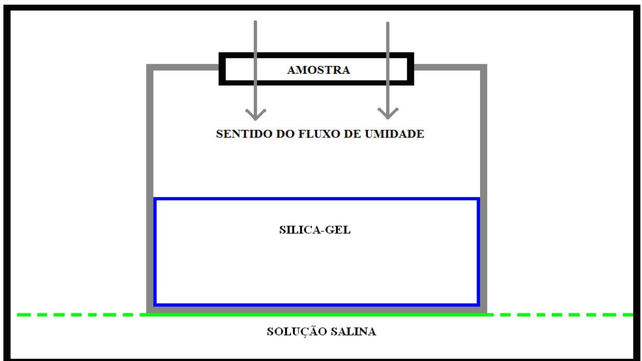
Figura 28 – Esquema do ensaio de permeabilidade ao vapor.
