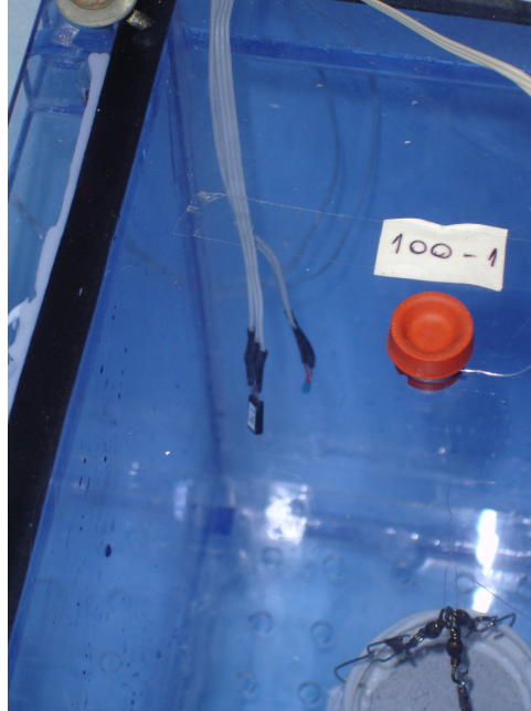
Figura 31 – Sondas utilizadas pelos sensores de temperatura e umidade.
