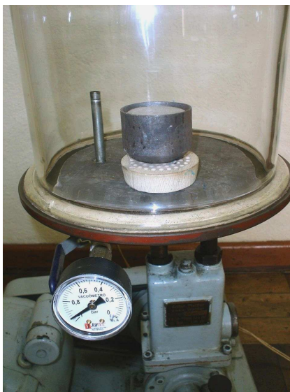
Figura A4: Câmara de vácuo e o manômetro.
