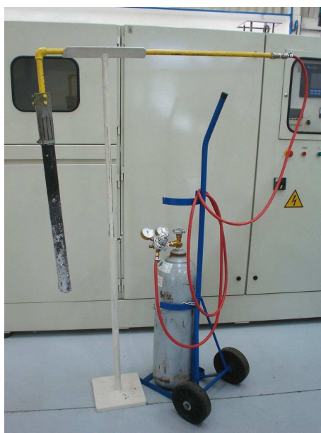
Figura A1: Equipamento para desgaseificação do tipo ponta porosa.
