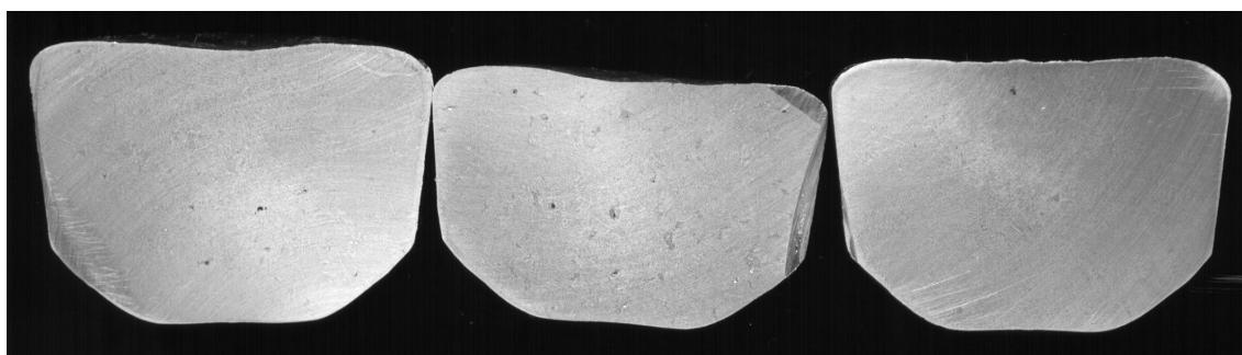
Figura A6: Amostras não degaseificadas e solidificadas em câmara de vácuo.
