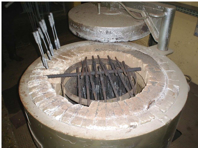
Figura 3.7: Forno elétrico com circulação de ar forçado, utilizado no tratamento térmico de solubilização e envelhecimento.
