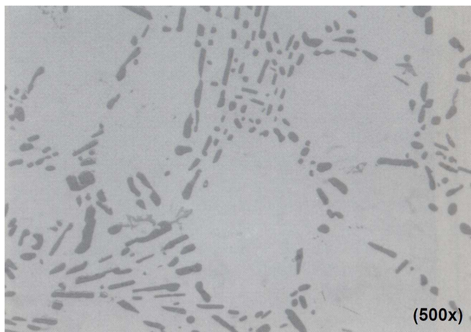
Figura 2.36: Partículas de Si separadas após o aquecimento durante 2 h a 540 °C (APELIAN; SHIVKUMAR; SIGWORTH, 1989).
