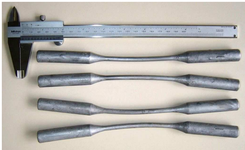
Figura 4.15: Deformação dos corpos de prova obtidos por fundição sob pressão após o tratamento térmico de solubilização a 520 °C, durante 5 h.
