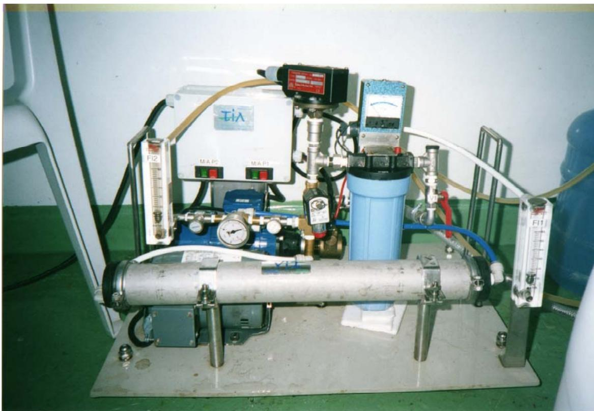
**Figura 19:** Foto do sistema de filtração por osmose reversa (OR). Filmtec TW30 tamanho 2514 – diâmetro de 2,5 polegadas e largura de 14 polegadas. O sistema foi utilizado para concentrar um volume aproximadamente de 200 L em 1 – 2 L de fração dissolvida e coloidal das amostras coletadas em lagos de águas pretas e das amostras previamente filtradas na ultrafiltração tangencial (UFT), no período de enchente (março) de 2006.
