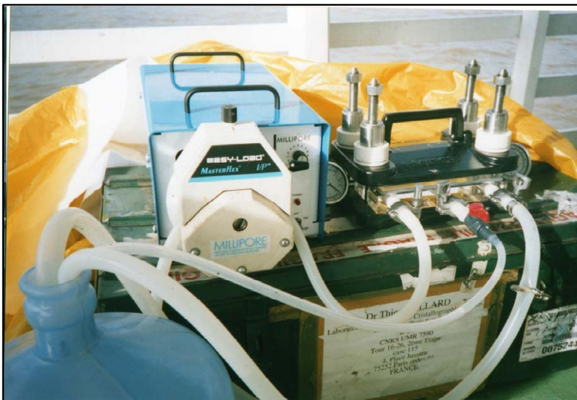
**Figura 18:** Foto do sistema de ultrafiltração tangencial (UFT). Filtração realizada com duas membranas de  $0,22\ \mu\text{m}$  nas amostras coletadas em Óbidos e nos lagos de águas brancas, ricos em material particulado em suspensão (MPS); e fluorescência fitoplanctônica (duas amostras), no período de enchente (março) de 2006.
