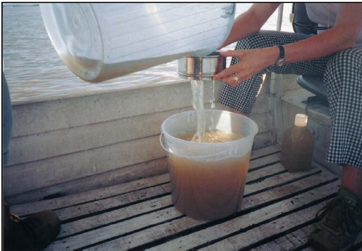
**Figura 16:** Foto do fracionamento do material particulado em suspensão (MPS) em peneira com poro de 63  $\mu\text{m}$  numa amostragem de águas brancas em período de enchente (março de 2004).
