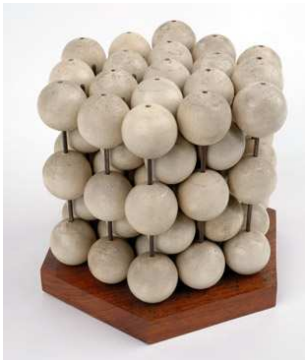
Figura 38 – Modelo de átomos com empacotamento conhecido como hexagonal compacto. (imagem cortesia do the Whipple Museum – código Wh.3297).
