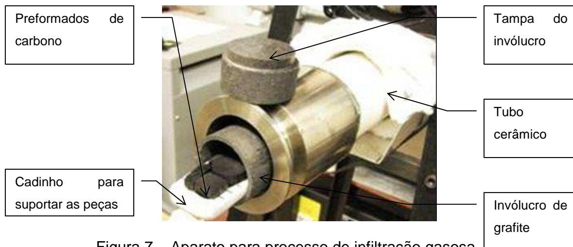
Figura 7 – Aparato para processo de infiltração gasosa.
