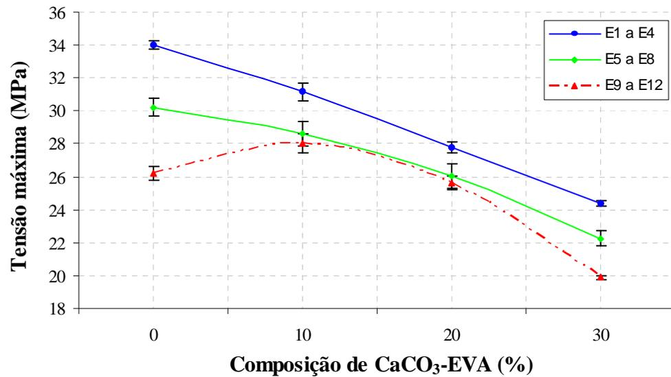
**Figura 6.18** Tensão máxima dos compósitos obtidos por extrusão.
