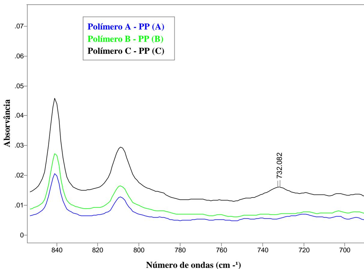
**Figura 6.7** Espectro IR do copolímero de poli(etileno-co-propileno).
