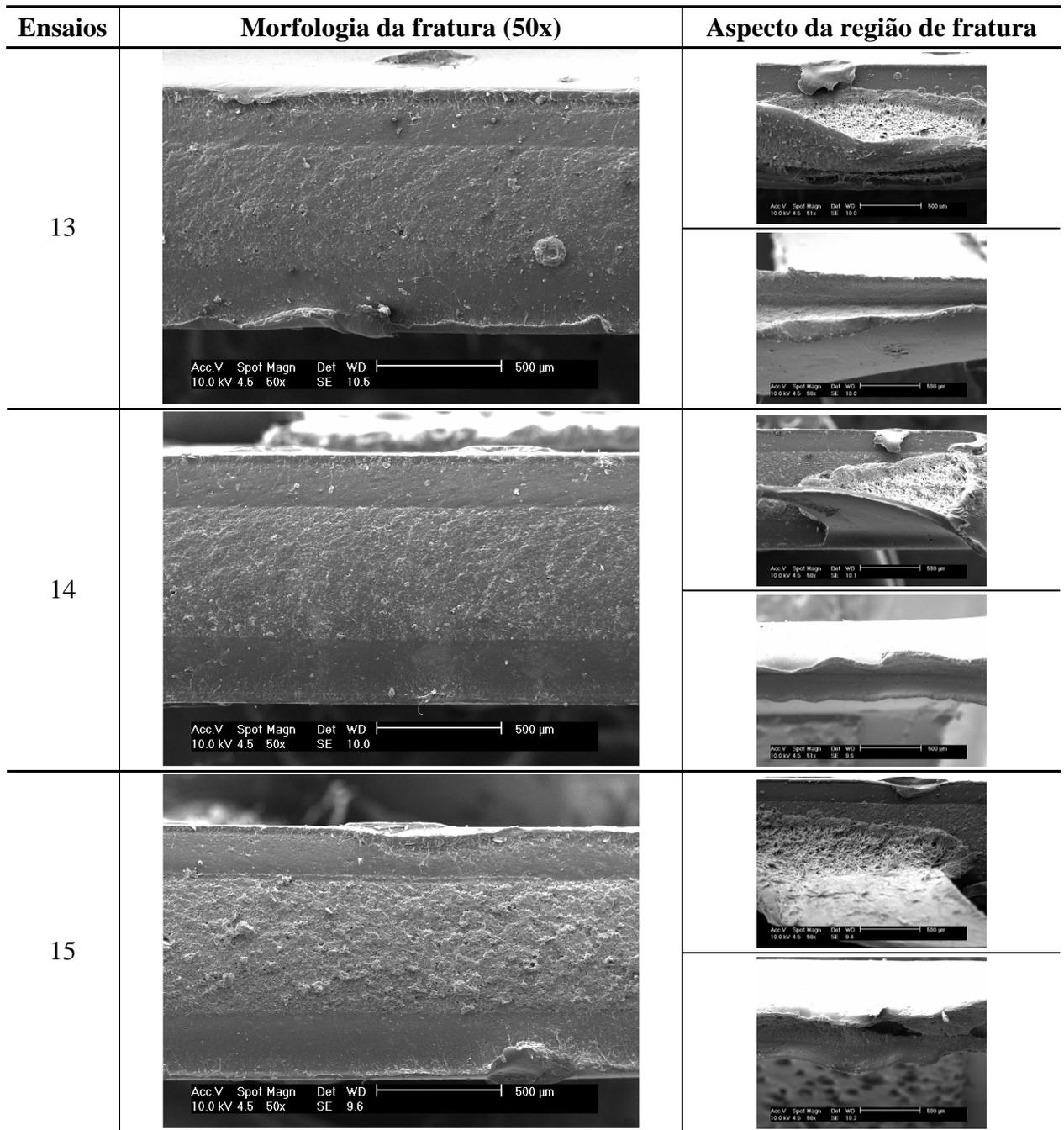
**Figura 6.25** Morfologias das fraturas do processo de co-extrusão obtidas em ensaio de tração.
