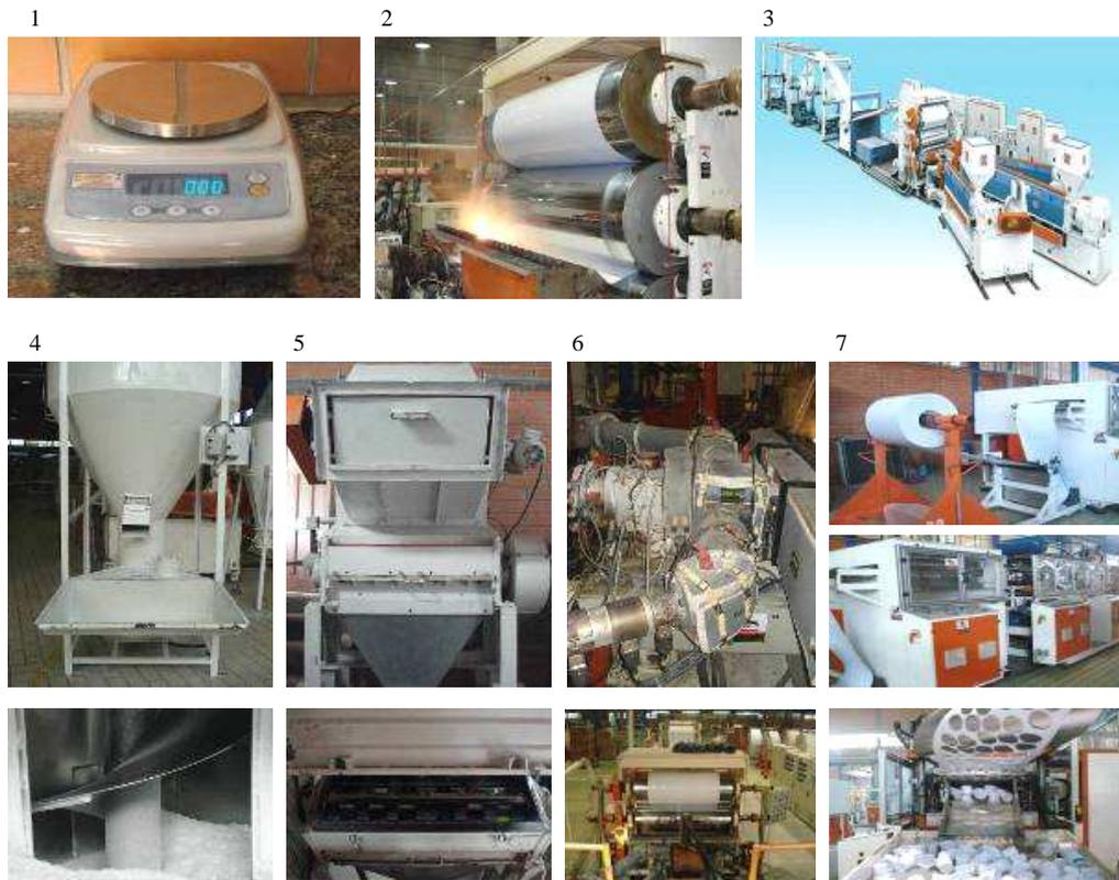
**Figura 5.2** Ilustração dos equipamentos do processo: (1) balança, (2) calandras, (3) extrusora, (4) misturador, (5) moinho, (6) co-extrusora e (7) termoformadora.
