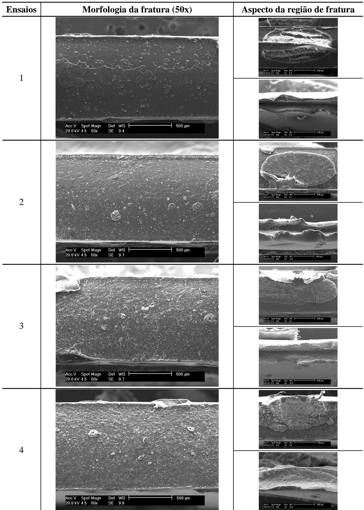
**Figura 6.24** Morfologias das fraturas do processo de extrusão obtidas em ensaio de tração.
