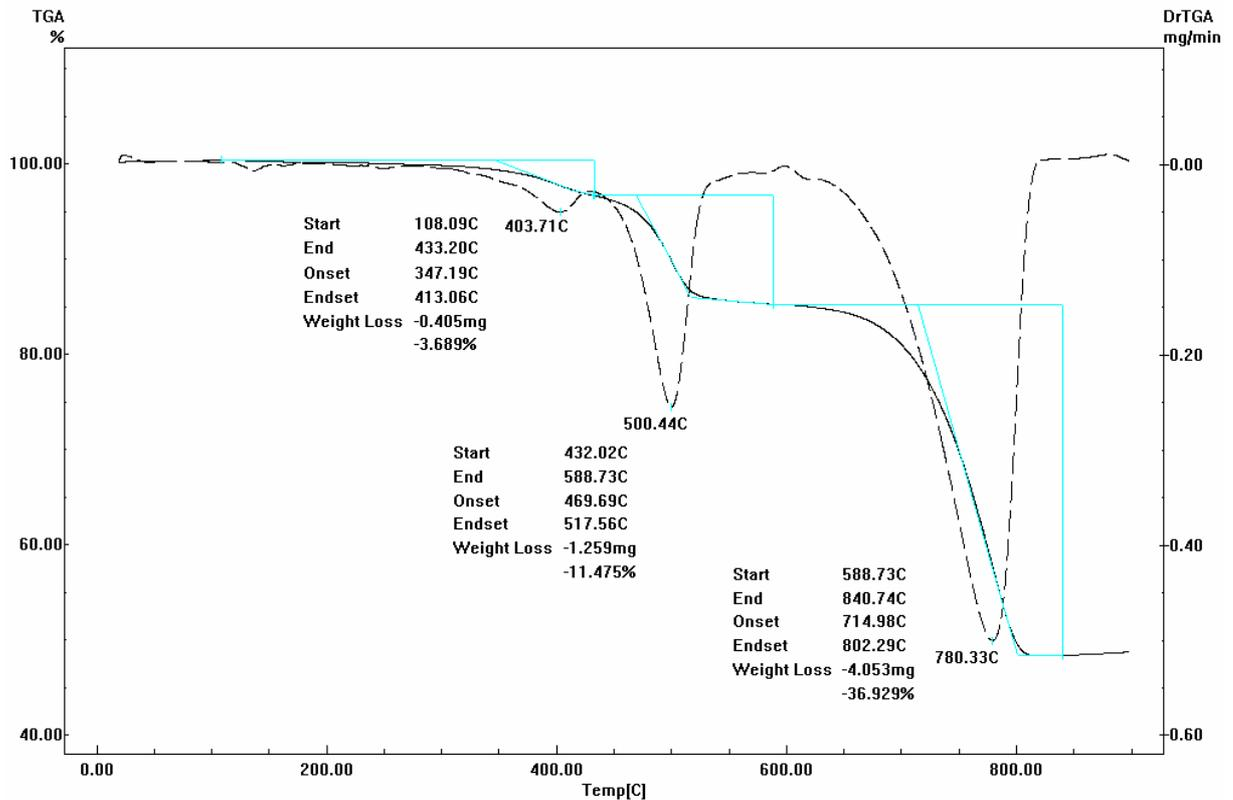
**Figura 6.13** Curvas *TG* (linha sólida) e *DTG* (linha tracejada) da degradação térmica para a composição de  $\text{CaCO}_3$ -EVA que ocorreu em três estágios.
