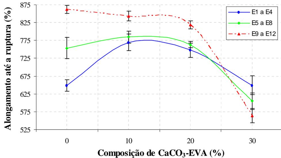
**Figura 6.26** Alongamento até a ruptura dos compósitos obtidos por extrusão.
