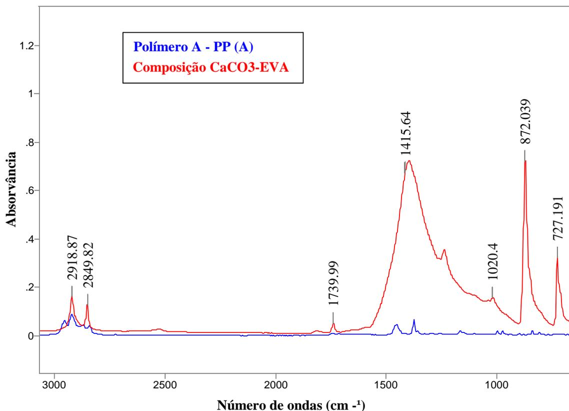
**Figura 6.8** Espectro IR do polímero A e da composição CaCO<sub>3</sub>-EVA.
