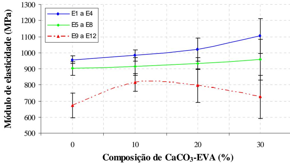
**Figura 6.28** Módulo de elasticidade dos compósitos obtidos por extrusão.
