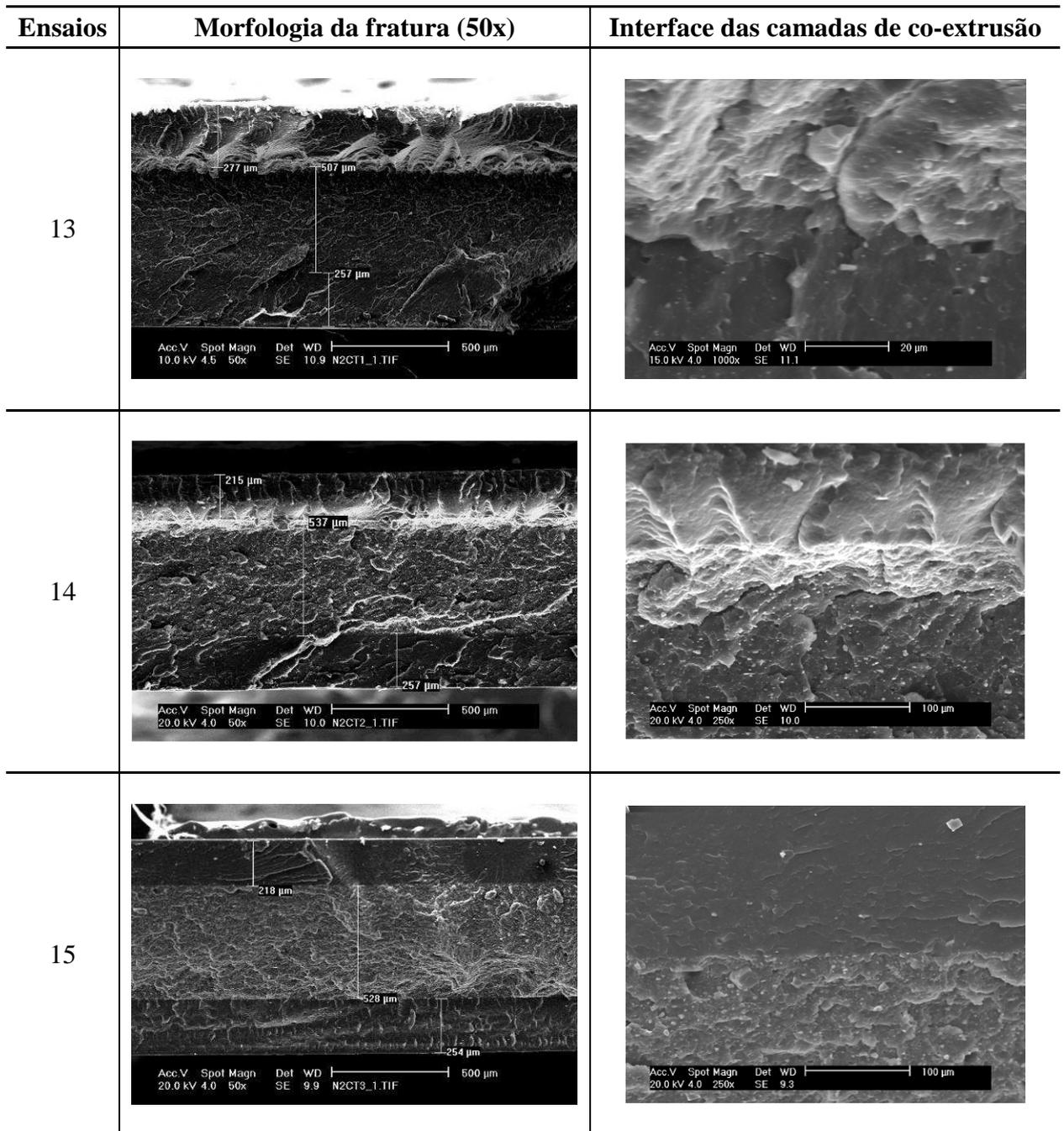
**Figura 6.31** Morfologias das fraturas criogênicas do processo de co-extrusão.
