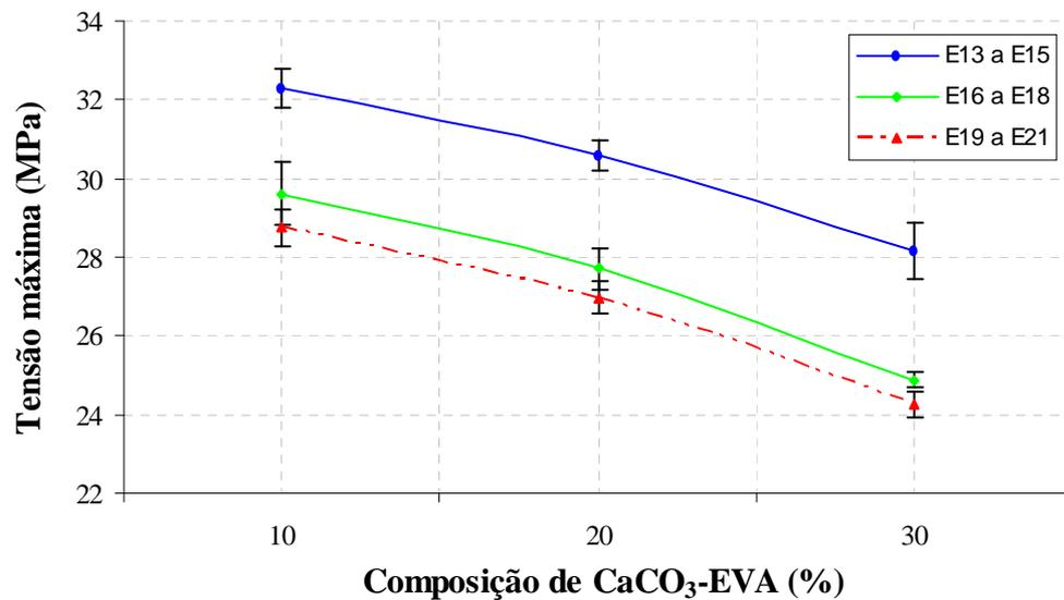
**Figura 6.19** Tensão máxima dos compósitos obtidos por co-extrusão.
