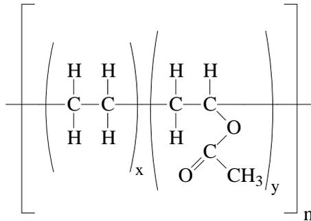
**Figura 4.4** Estrutura molecular do mero do poli(etileno-co-acetato de vinila) [13].
