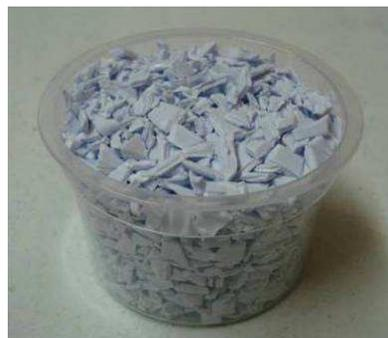
**Figura 5.5** Material triturado das chapas extrudadas para confecção dos corpos de prova.
