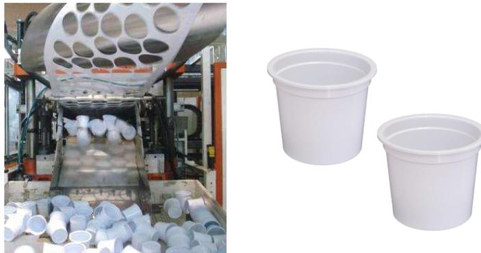
**Figura 4.13** Produção de embalagens de polipropileno a partir da chapa termoplástica.
