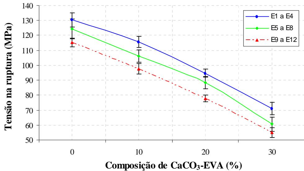
**Figura 6.22** Tensão na ruptura dos compósitos obtidos por extrusão.
