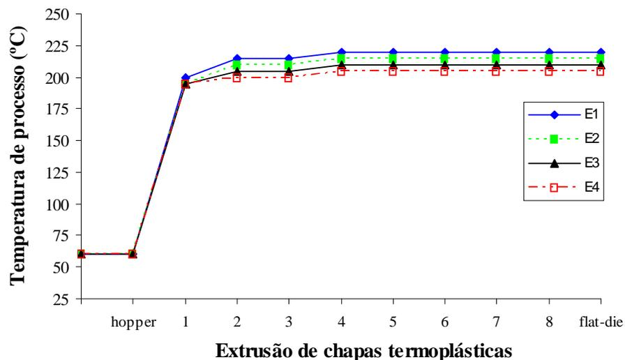
**Figura 6.1** Faixas de temperaturas dos ensaios 1 a 4.
