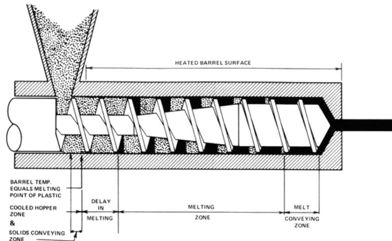
**Figura 4.9** Corte lateral de uma extrusora mostrando as várias funções da rosca [9].
