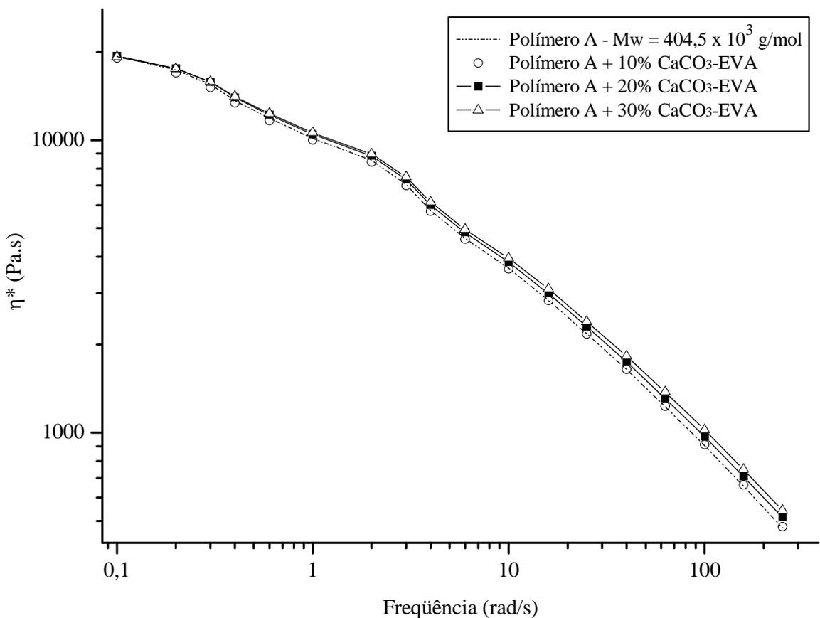
**Figura 6.33** Viscosidade dos compósitos de polipropileno a 190°C em função da frequência.
