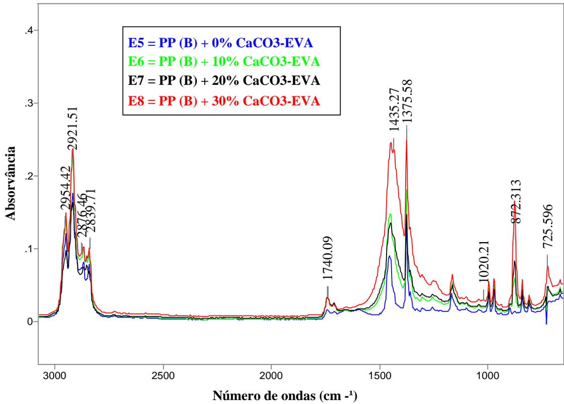
**Figura 6.10** Espectro IR do PP (B) + CaCO<sub>3</sub>-EVA - Ensaios (5 a 8).
