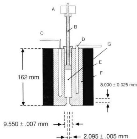
**Figura 5.8** Plastômetro de extrusão. (A) carga; (B) êmbolo; (C) aquecedor; (D) termômetro; (E) isolamento; (F) estrutura principal; (G) canal de aquecimento [37].
