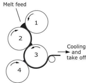
**Figura 4.12** Processo de calandragem utilizado na produção de filmes e chapas [8].
