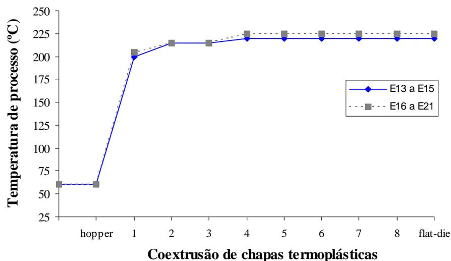
**Figura 6.4** Faixas de temperaturas dos ensaios 13 a 21.
