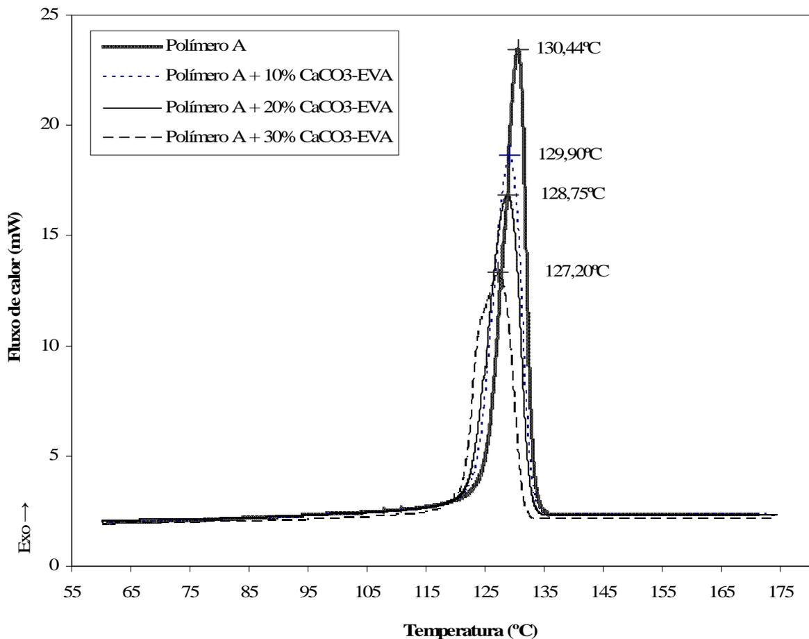
**Figura 6.16** Cristalização dos compósitos em função da temperatura.
