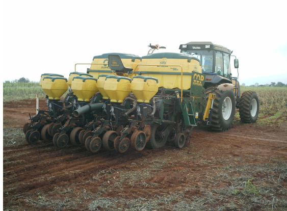
Conjunto trator-semeadora-adubadora para adubação em pré-semeadura
