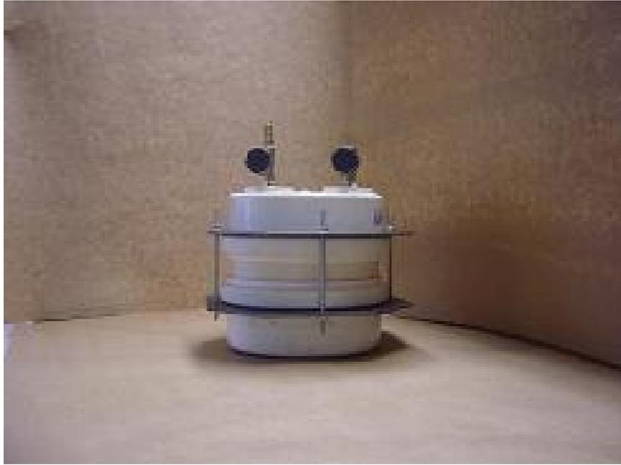
Figura 4.4: Detalhe do anel de segurança encaixado no reator.
