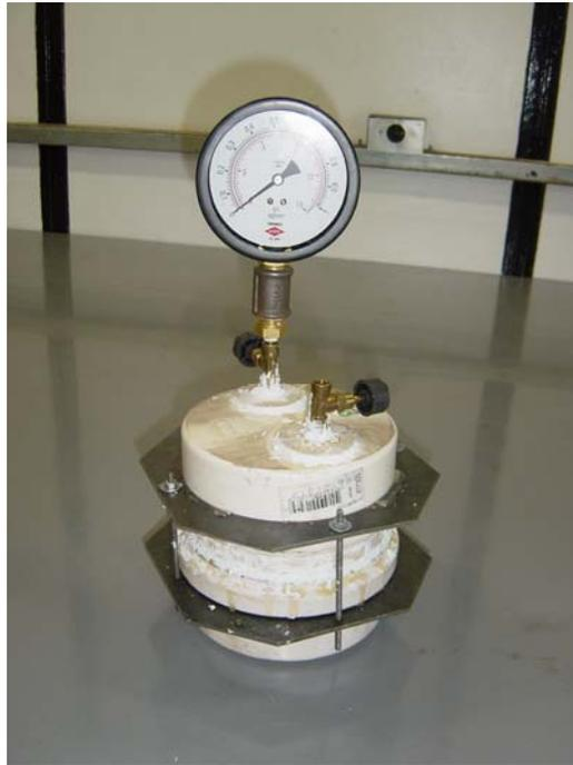
**Figura D. 1** – Leitura de pressão interna do reator
