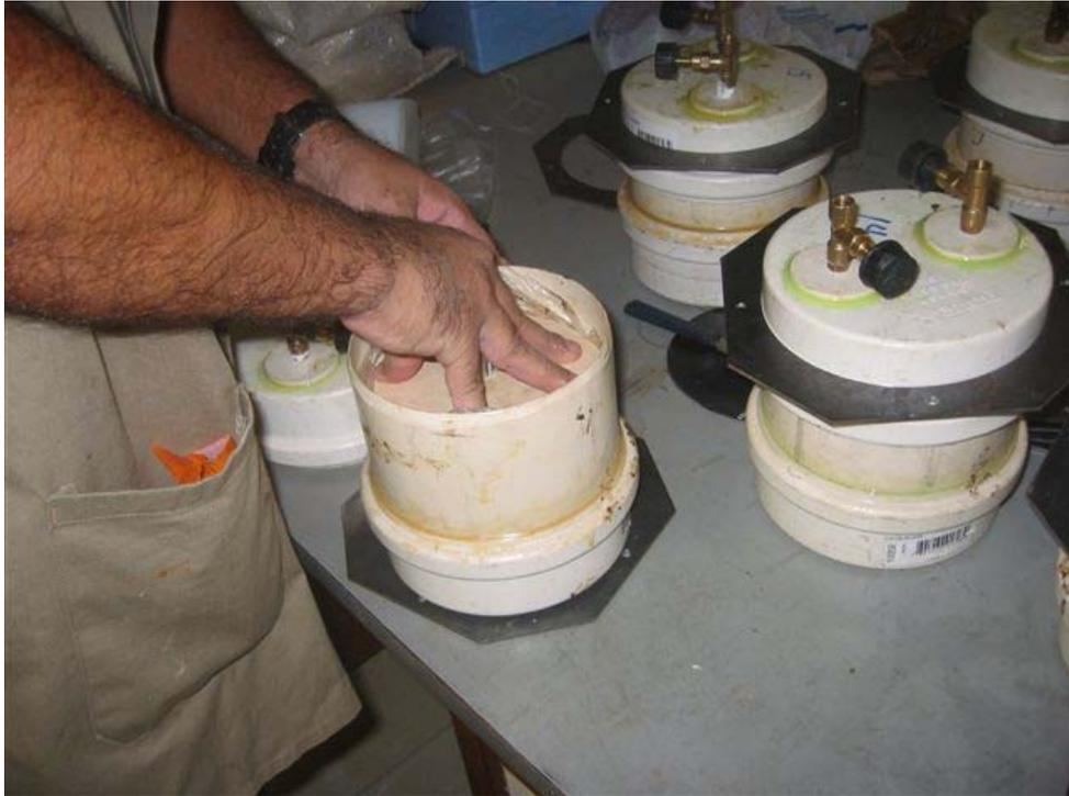
Figura 4.13 – Compactação do Meio de Reação
