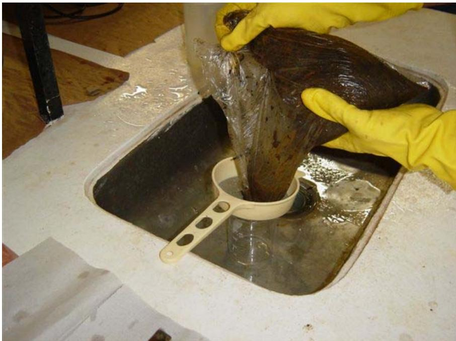
**Figura D.4** – Coleta do percolado do Meio de Reação
