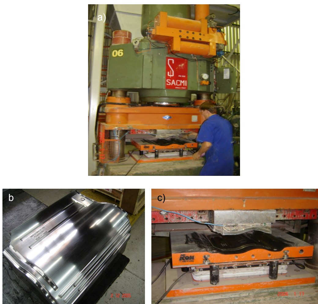
Figura 20 – a) Prensa SACMI 550 ton. b) Punção Superior. b) Conjunto Estampo - Matriz.
