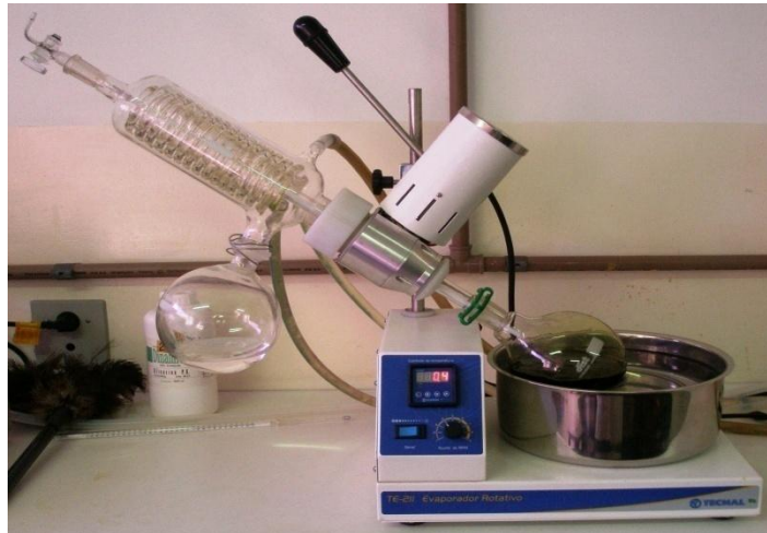
Figura 6: Evaporador rotatório sob pressão reduzida concentrando a amostra.
