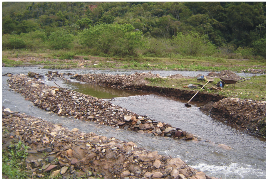
Figura 5.30 – Garimpo atual nos rejeitos gerados no século XVII, com granulometria variada.
