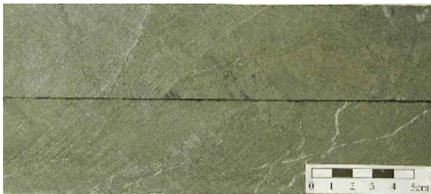
Figura 5.15 – Fotografia que mostra rocha vulcânica máfica com clorita. Fonte: CVRD (2003).
