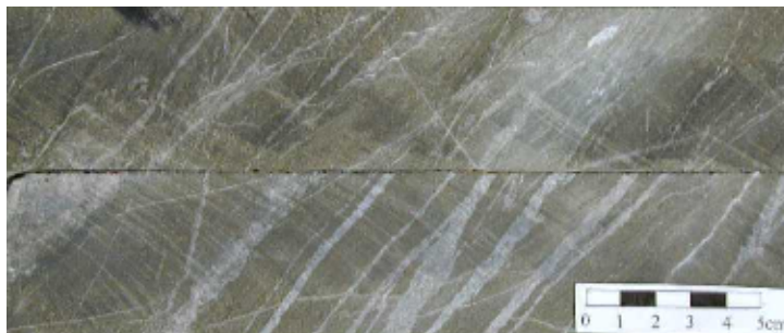
Figura 5.8 – Fotografia que mostra rocha vulcânica máfica biotítica que contém vênulas de quartzo deformadas em regime dúctil. Fonte: CVRD (2003).
