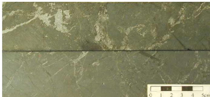
Figura 5.10 – Fotografia que mostra rocha vulcânica máfica composta essencialmente por hastingsita. Fonte: CVRD (2003).
