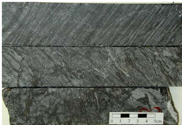
Figura 4.7 – Fotografia que mostra formação ferrífera a quartzo e magnetita, evidenciando o aumento da brechagem em direção à base do pacote. Fonte: CVRD (2003).
