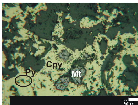
Figura 5.7 – Fotomicrografia que mostra inclusões de pirita em calcopirita e de calcopirita preenchendo fraturas na magnetita. Esta lâmina é referente ao furo 191 no intervalo 158 a 159m (polarizadores paralelos, dados deste trabalho).
