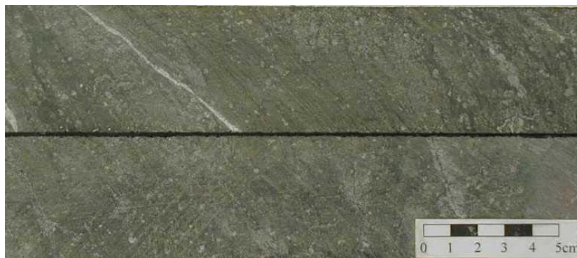
Figura 4.3 – Fotografia de testemunho de sondagem correspondente a rocha (sub) vulcânica félsica com pórfiros de quartzo isolados em matriz de biotita e clorita que apresenta vênulas de calcita. Fonte: CVRD (2003).
