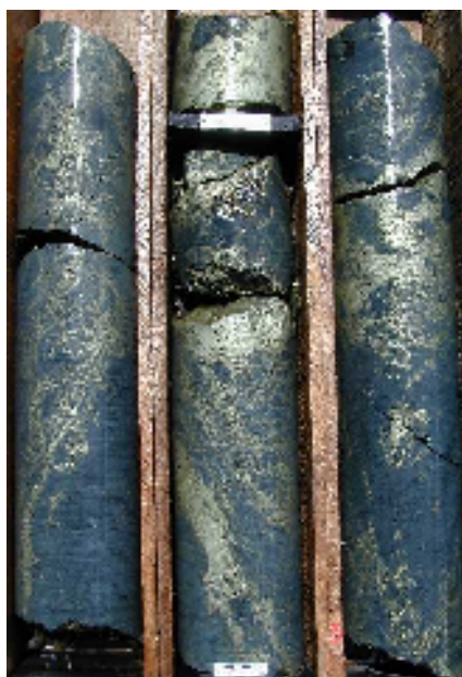
Figura 5.17 – Fotografia que mostra rocha vulcânica máfica entrecortada por expressivo stockwork de vênulas de sulfetos. Fonte: CVRD (2003).
