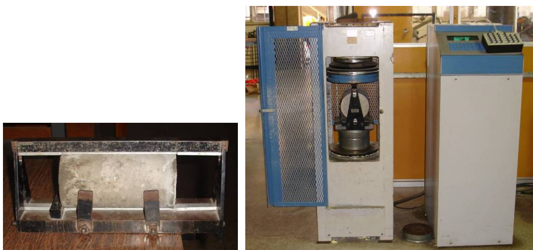
Fig. 7.18: Compressão diametral – máquina de ensaios ELE.
