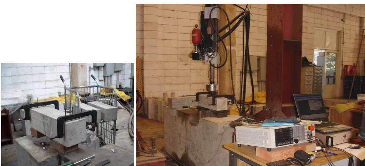
Fig. 7.33: Ensaio de Fraturamento – Série 2: corpos-de-prova e execução do ensaio.
