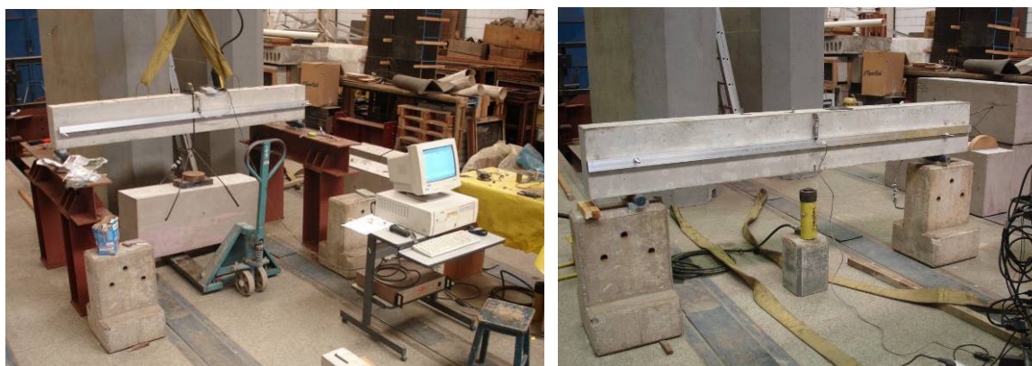
Fig. 7.20: Ensaio de flecha inicial – Série 1 (Piloto).
