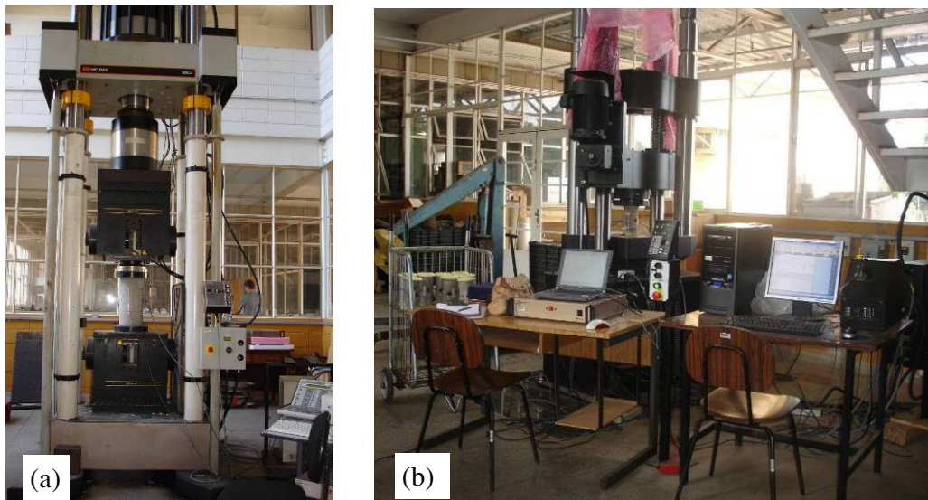
Fig. 7.16: Compressão axial: (a) Instron – 8506 (250 ton.) (b) Instron – 5595 (150 ton.).
