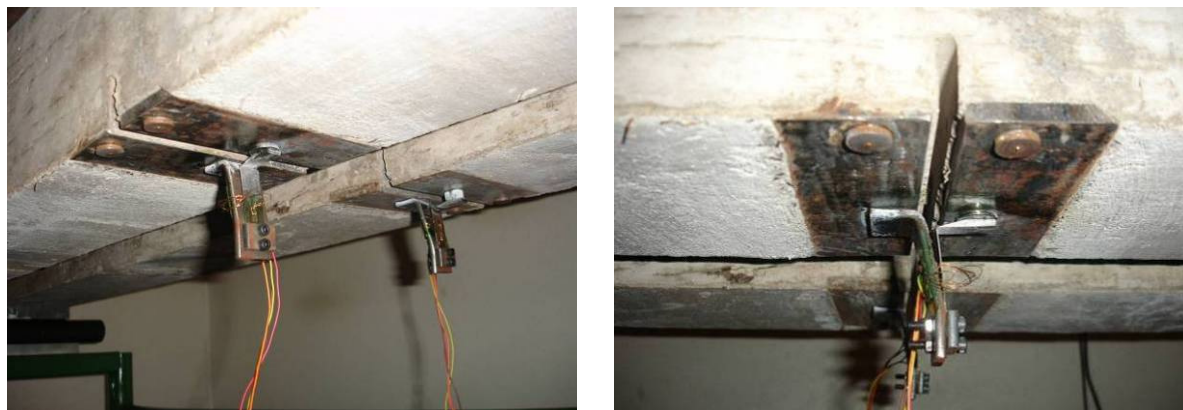
Fig. 7.30: Clip-on-gage utilizado na Série 2.
