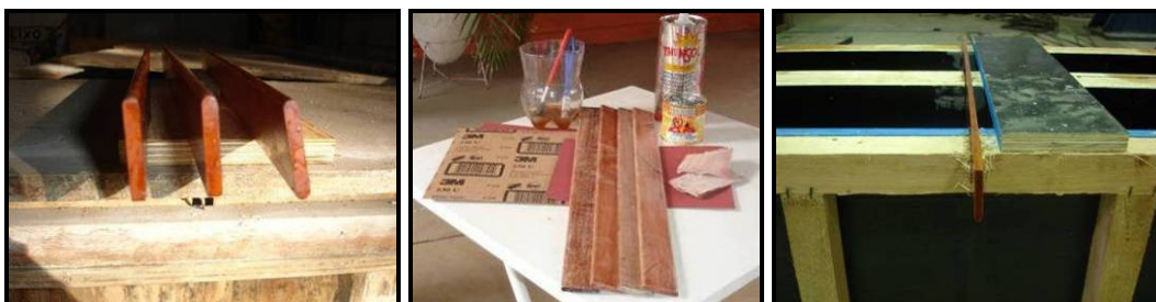
Fig. 7.8: Peça de inserção em madeira para confecção do entalhe.
