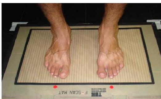
**Figura 14:** Posicionamento dos pés na plataforma F-SCAN/F-MAT
