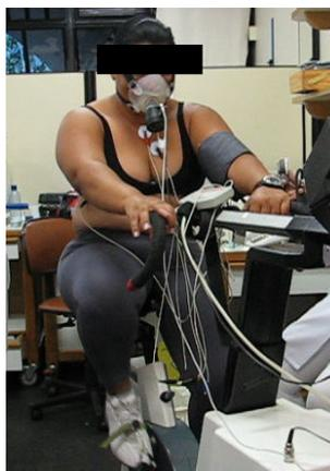
**Figura 4** – Realização do teste ergoespirométrico máximo em cicloergômetro.
