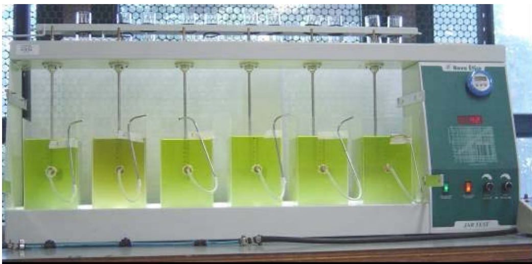
Figura 4.6 - Foto do equipamento “Jartest” utilizado nos ensaios de sedimentação
