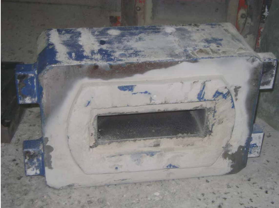
Figura 3.16 – Caixa matriz de tijolos de alumina para revestimentos.
