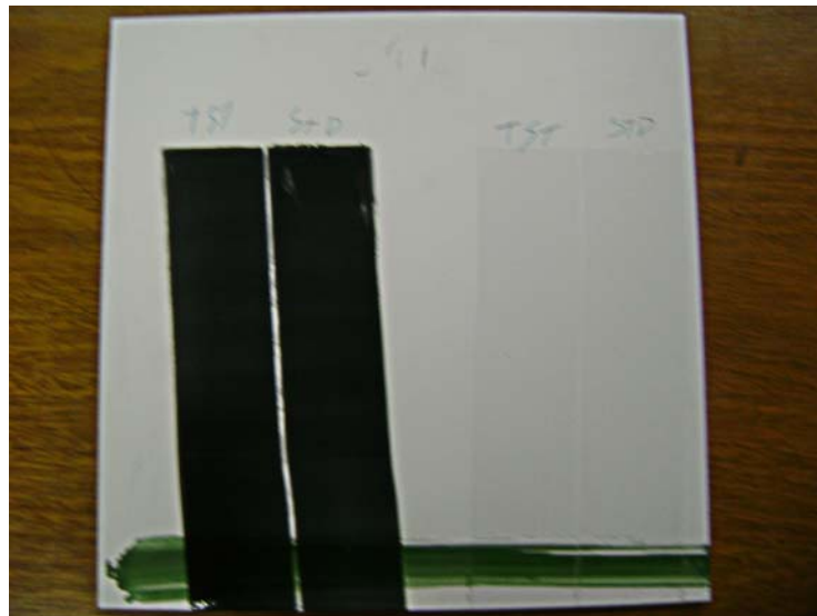
Figura 3.13 – Aplicação de esmalte branco e preto para teste de qualidade do esmalte em placa cerâmica.
