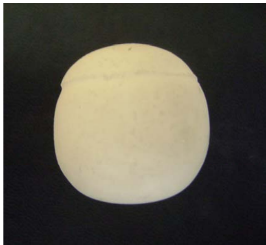
Figura 3.9 – Esfera produzida com prensagem isostática.
