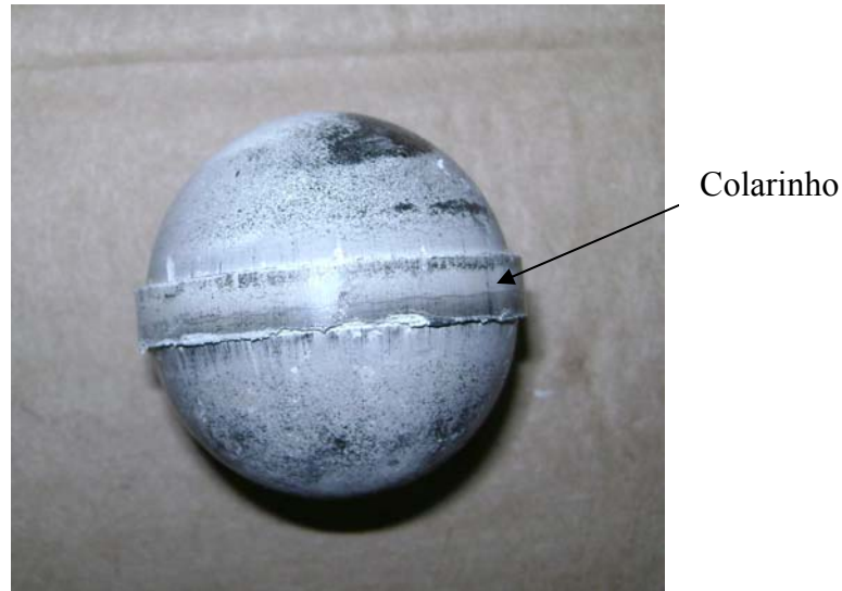
Figura 3.10 – Colarinho formado no esferóide após a prensagem hidráulica.
