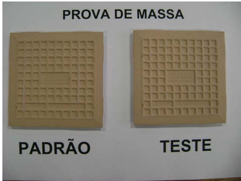
Figura 3.14 - Prova de compactação com massa cerâmica produzida através dos corpos moedores compactados através da prensagem hidráulica do modelo.
