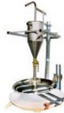
Figura 2.7 – Aplicação de esmalte (véu campana) (KINGERY, 1998).
