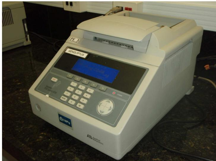
FIGURA 10: Termociclador da marca GeneAmp PCR System 9700 (Applied Biosystems, Foster City, CA, EUA).
