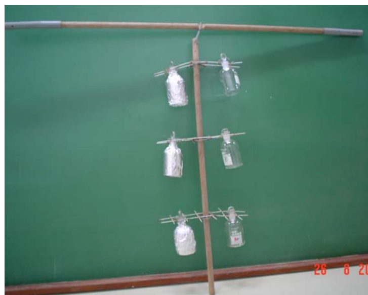
Figura 4.11. Aparato utilizado no ensaio de frascos claros e escuros
