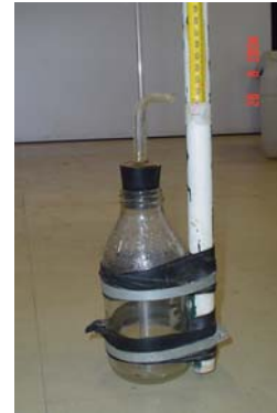
Figura 4.10b: Detalhe do coletor de amostra em profundidade
