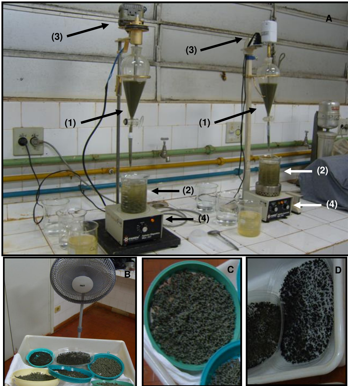
Figura 2. Preparo dos microgrânulos de alginato de sódio contendo conídios do isolado E9 de Metarhizium anisopliae . A: mucilagem de alginato de sódio contida em funil de separação (seta 1), sendo gotejada em solução de cloreto de cálcio (seta 2), ambos sob agitação constante (setas 3 e 4); B e C: microgrânulos submetidos a ventilação forçada para secagem; C: microgrânulos após secagem por algumas horas.
