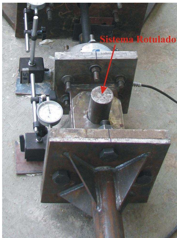
Figura 3.14 - Chapa de extremidade e sistema rotulado para a aplicação de tração às diagonais.
