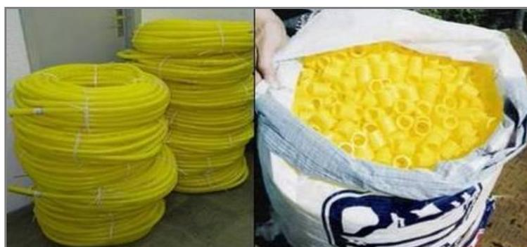
**Figura 4.2** - Meio suporte - conduítes inteiros e anéis cortados.
