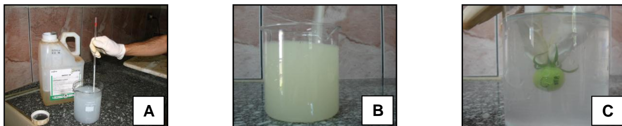
Figura 3. Diluição do inseticida em Becker de vidro (A) e agitação da calda com bastão (B) para a posterior imersão do fruto (C) infestado com ovos de Neoleucinodes elegantalis .
