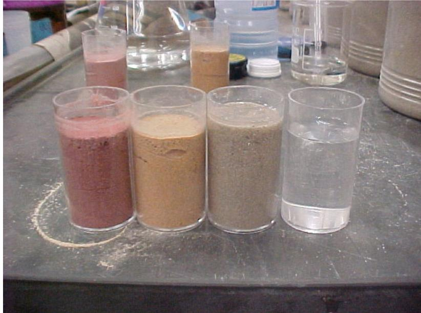
**Figura 9.** Da esquerda para a direita, silte, saibro e arenito. O último recipiente contém água, para os experimentos com umidade.
