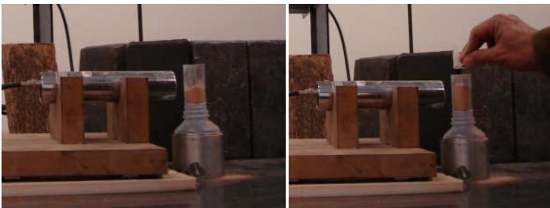
**Figura 11.** Experimento para medida da influência do volume de solo no espalhamento da radiação.
