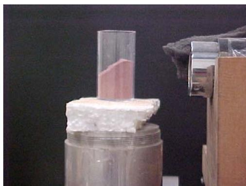
**Figura 13. Centralização do detector em relação à amostra.**
