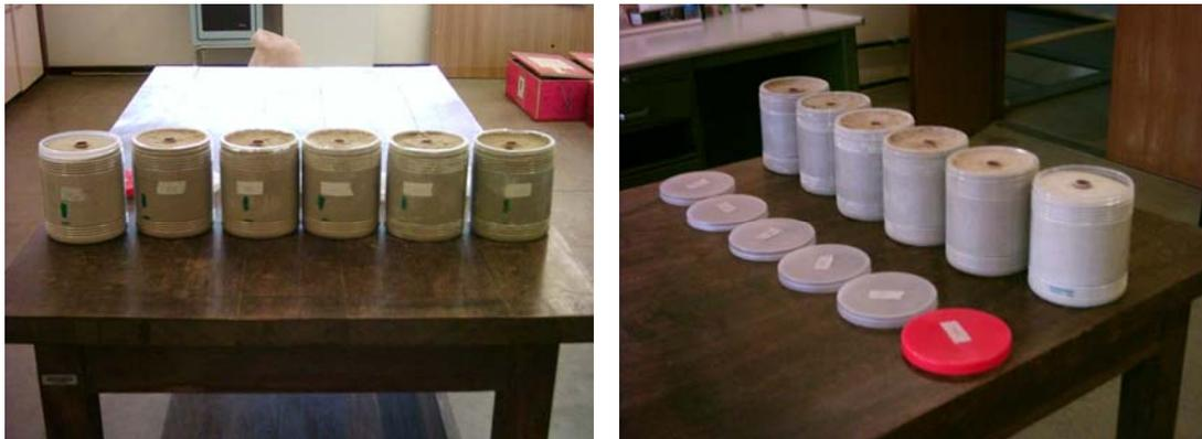
**Figura 17. Amostras de solo com umidade determinada.**
