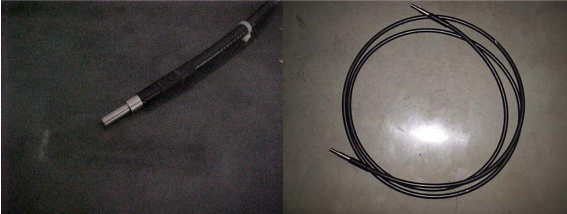
**Figura 7. Esquerda - detalhe da ponta de um guia líquido; direita - um guia líquido de 3 metros de comprimento (Silva, 2004).**
