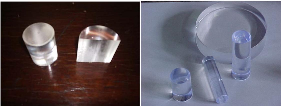
**Figura 6.** Esquerda: cintilador orgânico inteiro e um cortado ao meio, para ser usinado e polido antes de sua utilização; direita: cintiladores orgânicos utilizados no experimento (Silva, 2004).
