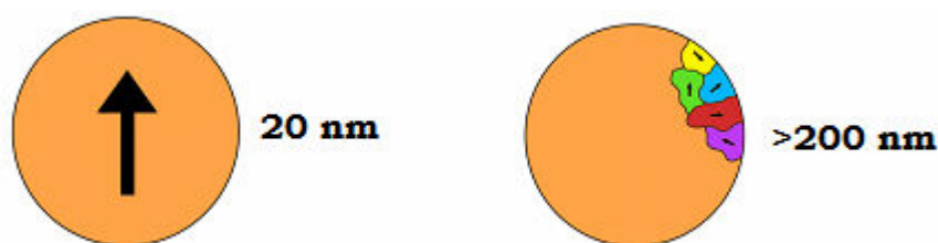
Figura 8: Influência do tamanho das partículas no comportamento do vetor campo magnético. Na partícula de 20 nm há apenas um único domínio magnético, enquanto na de 200nm existem vários domínios magnéticos
