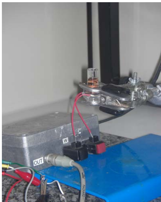
Figura 8: Microbalança eletroquímica à cristal de quartzo usada na monitoração da massa no eletrodo de cristal de quartzo.
