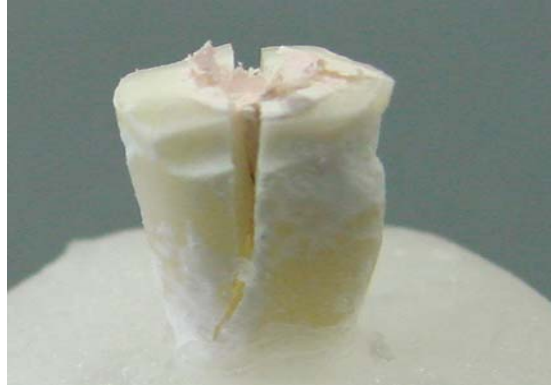
Figura 5 - Fratura do espécime após carga máxima suportada
