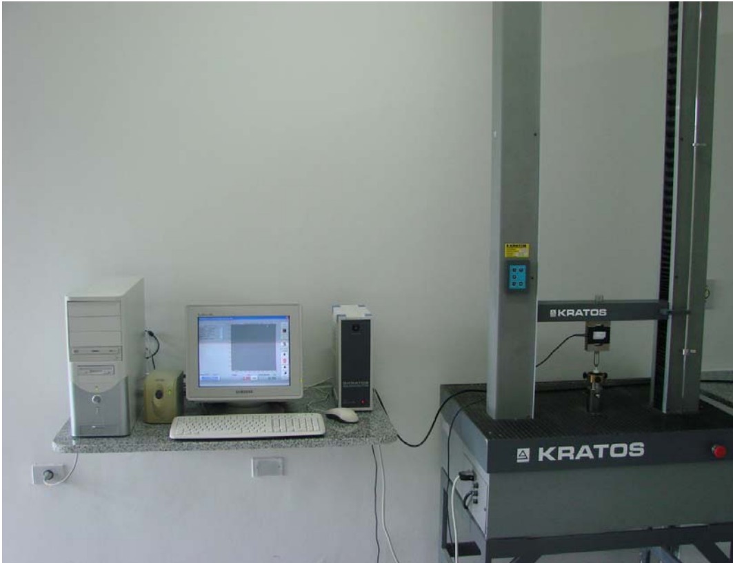
Figura 1 - Máquina universal de ensaios Kratos acoplada ao computador para registro de força e imagens gráficas
