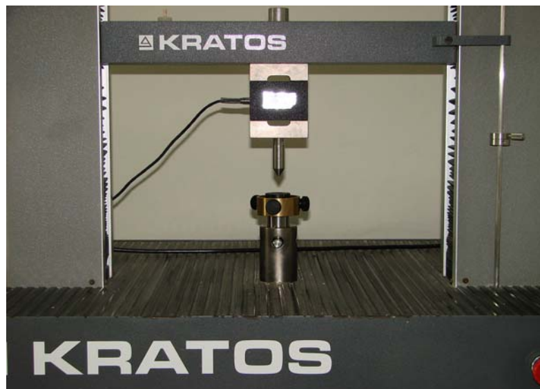
Figura 2 - Base metálica para inserção da amostra
