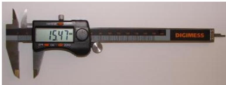
Figura 2 - Paquímetro Digital Digimess® 100.174BL
