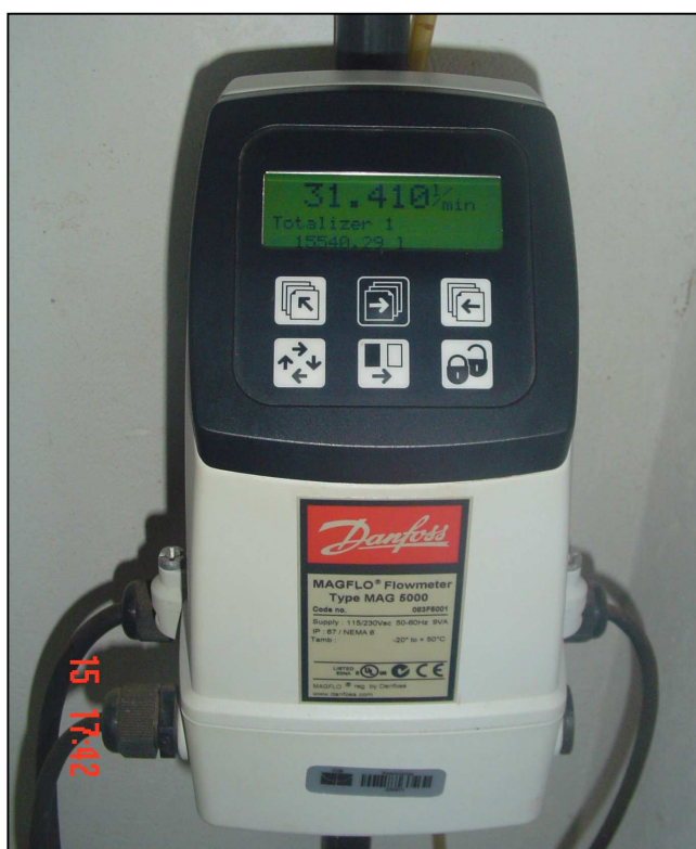
Figura 4.4 - Visor do Dispositivo Medidor de Vazão (DMV)
