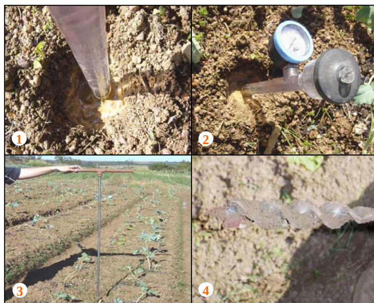
Figura 5.8 – Instalação dos tensiômetros (1 e 2) e trado utilizado na abertura dos furos (3 e 4).
