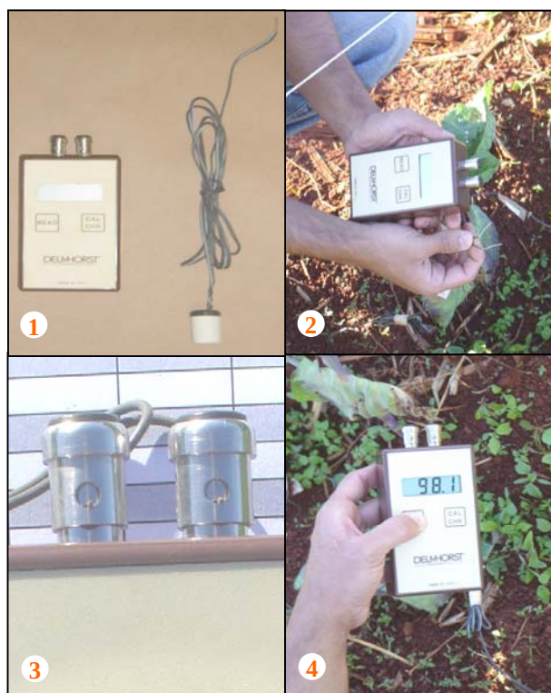
1 – aparelho de leitura e umidímetro de bloco de gesso; 2 – fios condutores do condutivímetro de bloco de gesso, antes de serem acoplados ao aparelho de leitura; 3 – fios condutores do umidímetro de bloco de gesso, depois de terem sido acoplados ao aparelho de leitura; e 4 – realização de uma leitura.
