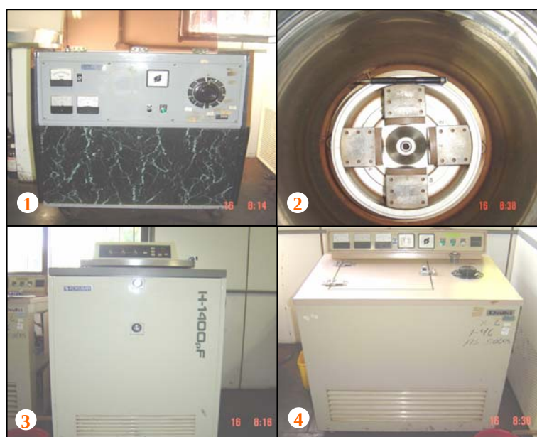
Figura 5.5 – Centrífugas utilizadas na determinação da curva de retenção de água no solo: 1 – Centrífuga modelo H-70; 2 – Visão interna da centrífuga destacando o rotor e as cápsulas da centrífuga modelo H-70; 3 – Centrífuga modelo 1400 PF; 4 – Centrífuga modelo DIK-560.
