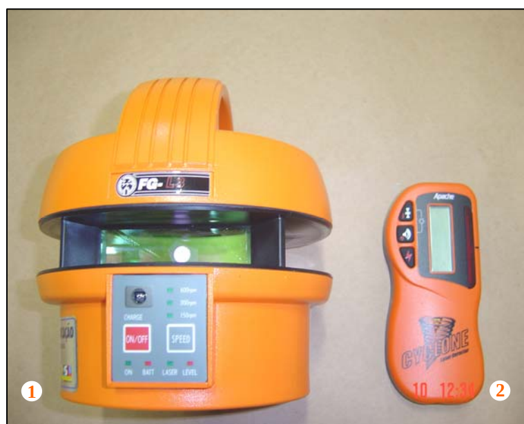
Figura 5.11 – Nível a Laser (1) e detector do laser, que fica preso à régua (2).
