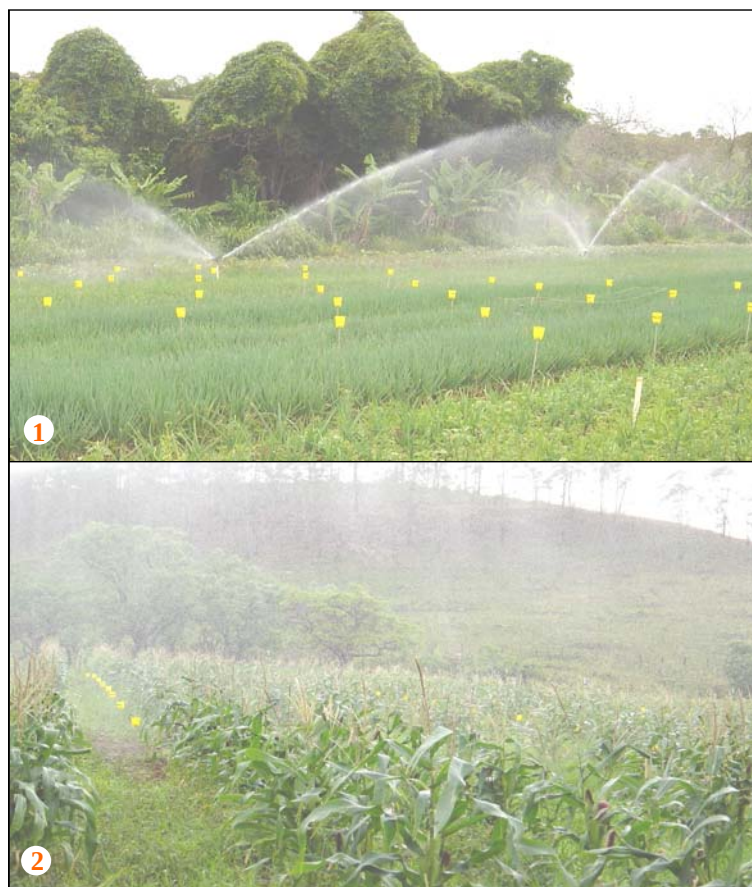
Figura 5.13 – Ensaio do levantamento da uniformidade de aplicação da água dos aspersores: 1 – Parcela A, propriedade P2; e 2 – Parcela B, propriedade P1.
