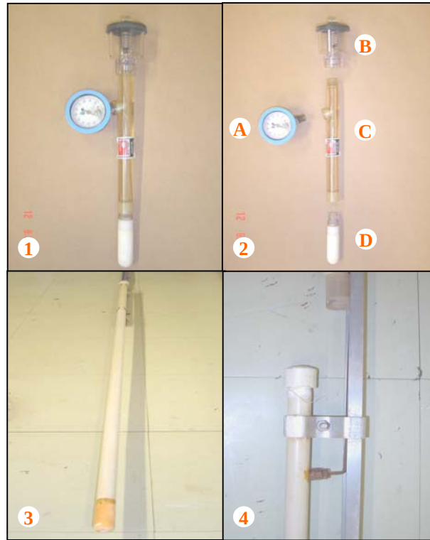
A – manômetro de vácuo; B – “jetfill”; C – tubo de acrílico, sendo o corpo do tensiômetro; D – cápsula porosa; e 4 – destaque da haste de alumínio que sustenta e protege o manômetro de mercúrio, e do tubo de ligação entre o tensiômetro, em material de PVC, e o manômetro de mercúrio.
