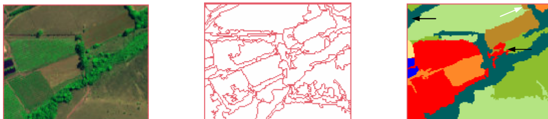
Figura 6.24 – Imagem multiespectral do QuickBird-2, resolução espacial de 2,8 m, (a) composição colorida 2(B)3(R)4(G) realçada, (b) imagem rotulada a partir das banda 1,2 e 3 com limiares de 7/100 (similaridade/área) e (c) imagem classificada.
