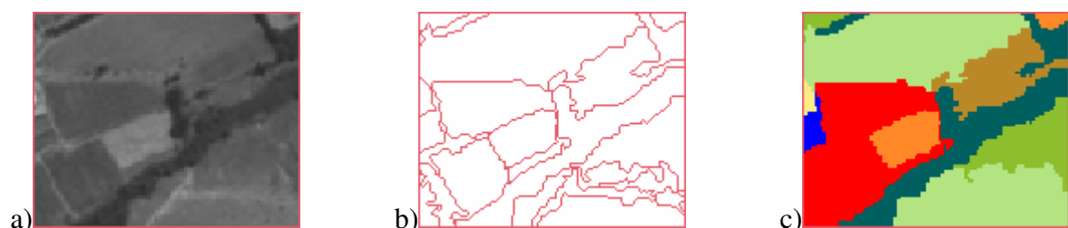
Figura 6.22 – Imagem pancromática do SPOT-5 com resolução espacial de 5 m, (a) original, (b) rotulada com limiares de 6/70 (similaridade/área) e imagem classificada (c).
