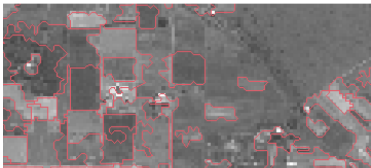
Figura 6.6 – Imagem rotulada a partir da banda pancromática de 10 m obtida pela reamostragem da pan 2,5 m com os limiares 8 para similaridade e 20 para área.
