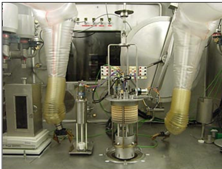
Figura 2.3.3: Vista interna da célula quente Caisson Fonte: http://itu.jrc.ec.europa.eu/index.php?id=173
