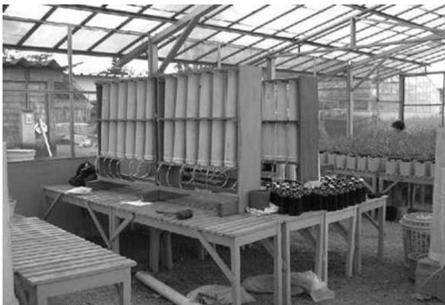
**FIGURA 1** Aspecto do experimento de lisímetros durante sua montagem.
